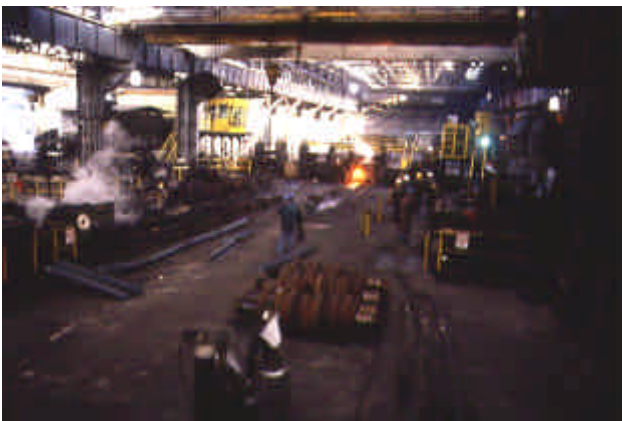
Figura 3.3.11. Treno per profilati. Gabbia reversibile, vie a rulli, spintori per la traslazione del ferro
