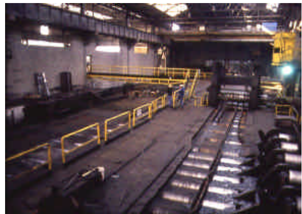
Figura 3.3.11. Treno per profilati. Gabbia reversibile, vie a rulli, spintori per la traslazione del ferro
