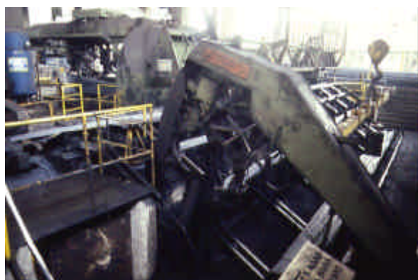
Figura 3.4.3. Profilato al termine della laminazione in ingresso alla placca Figura 3.4.4. Profilati. Piano di raffreddamento
