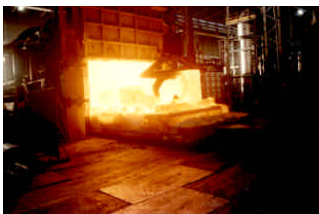
Figura 3.2.4. Impianto di tipo continuo. Forno a longheroni mobili ( walking beam )
