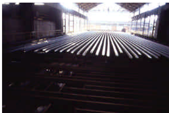
Figura 3.4.3. Profilato al termine della laminazione in ingresso alla placca Figura 3.4.4. Profilati. Piano di raffreddamento
