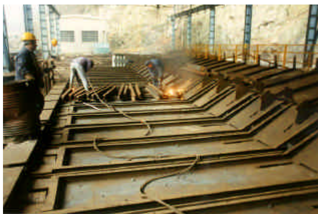
Figura 3.2.2. Scarfatura di un lingotto effettuate con cannello in postazione aspirata
