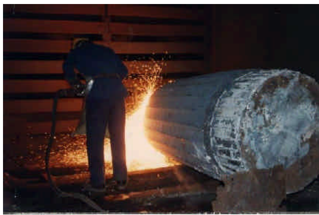
Figura 3.2.2. Scarfatura di un lingotto effettuate con cannello in postazione aspirata
