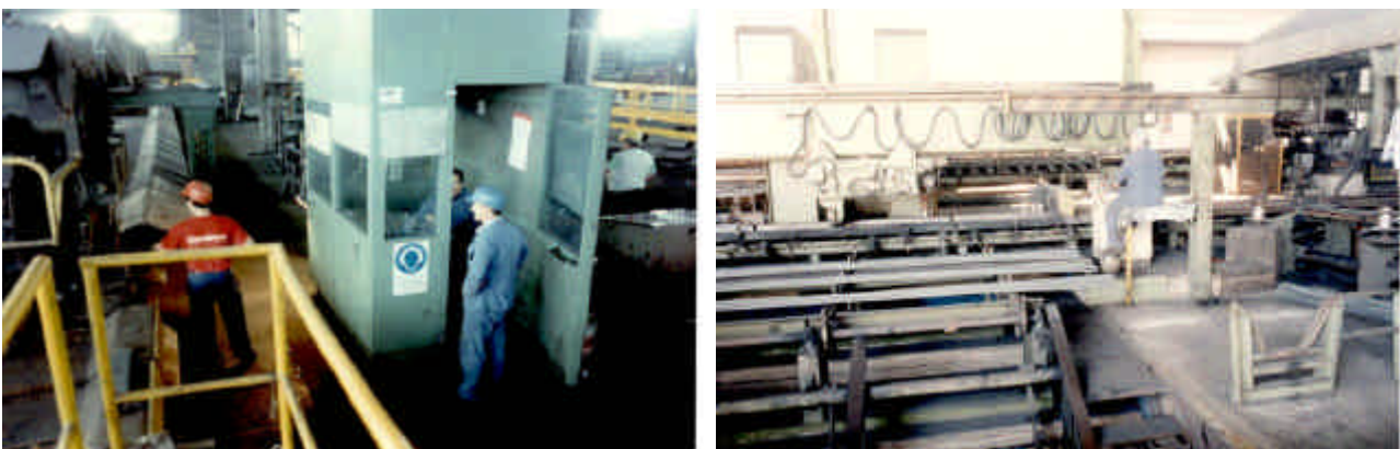
Figura 3.8.11. Area raccolta formazione del fascio. Postazione di manovra e sorveglianza non protetta
