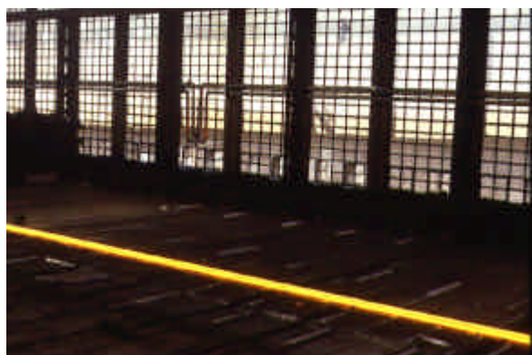
Figura 3.4.3. Profilato al termine della laminazione in ingresso alla placca Figura 3.4.4. Profilati. Piano di raffreddamento
