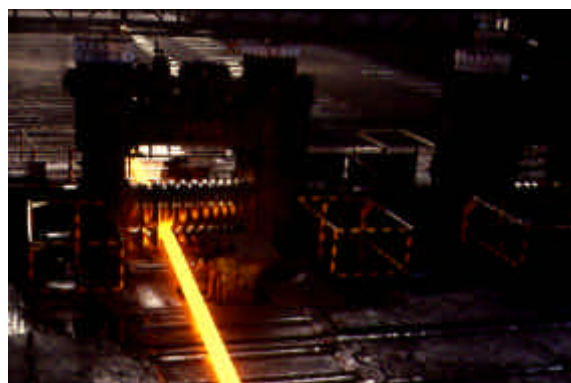
Figura 3.3.1. Treno di laminazione a funzionamento continuo per nastro. Cilindri di laminazione Figura 3.3.2. Gabbia di laminazione destinata a funzionamento reversibile
