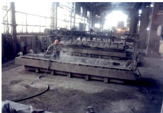
Figura 3.8.3. Demolizione rivestimento di sicurezza paniera con martello pneumatico Figura 3.8.4. Rifacimento manto di usura paniera con malta applicata a spruzzo
