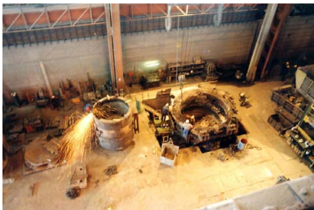
Figura 3.8.3. Demolizione rivestimento di sicurezza paniera con martello pneumatico Figura 3.8.4. Rifacimento manto di usura paniera con malta applicata a spruzzo
