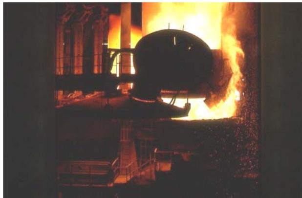
Al termine della fusione viene effettuata la scorifica, basculando il forno e facendo defluire all'esterno del forno, in una paiola o direttamente a terra, la scoria sovrastante il bagno.
