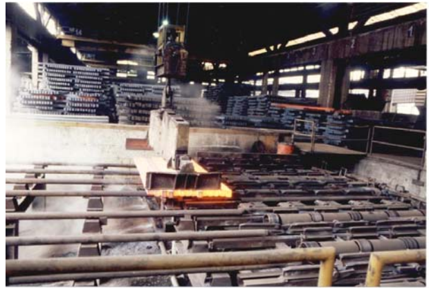
Figura 3.7.7. Taglio blumi con carrello ossitaglio. Figura 3.7.8. Prelievo billette tramite bilancino e messa a parco
