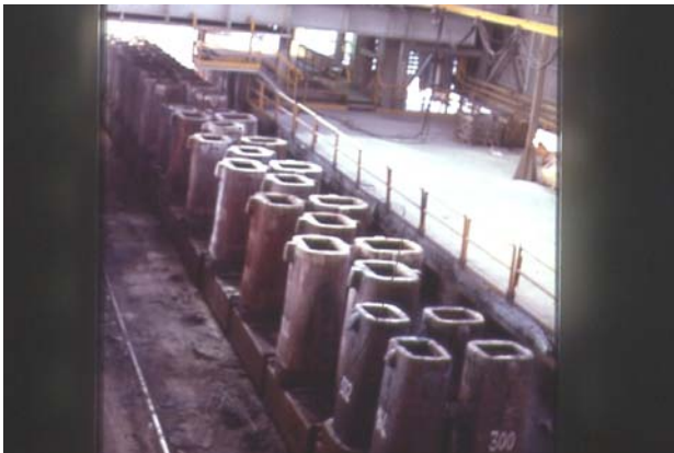
Figura 3.7.9. Lingottiere su carri di colata. Figura 3.7.10. Impalcato di colata con colaggio a piano lavoro Figura 3.7.11. Colaggio in lingottiera con metodo a sorgente, cioè con risalita dell'acciaio in canaletta centrale Figura 3.7.12. Prelievo di provino da siviera
