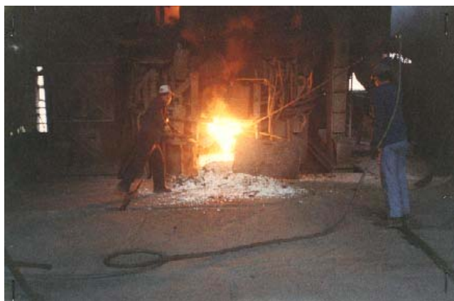
Figura 3.4.13. Insufflazione di ossigeno e carbone con lancia montata su manipolatore governato da cabina forno
