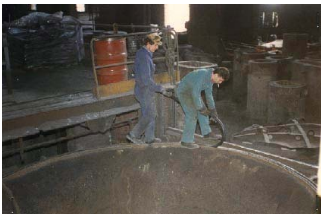
Interventi di manutenzione (sostituzione guarnizione) su impianto VD Raccolta di scarti e ribaltamento in siviera
