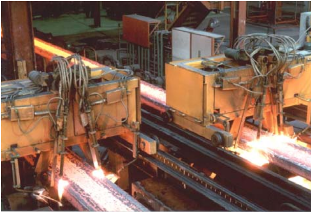
Figura 3.7.7. Taglio blumi con carrello ossitaglio. Figura 3.7.8. Prelievo billette tramite bilancino e messa a parco
