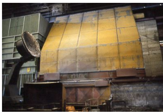
Figura 2.20. Dog-house chiusa, lato platea lavoro. Figura 4.21. Dog-house chiusa, lato spillaggio Figura 4.22. Dog-house aperta nella sezione inferiore durante affinazione Figura 4.23. Dog-house aperta nella sezione superiore (fase di carica e di spruzzaggio, come nell'immagine)
