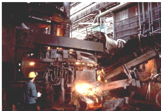
Figura 3.4.13. Insufflazione di ossigeno e carbone con lancia montata su manipolatore governato da cabina forno
