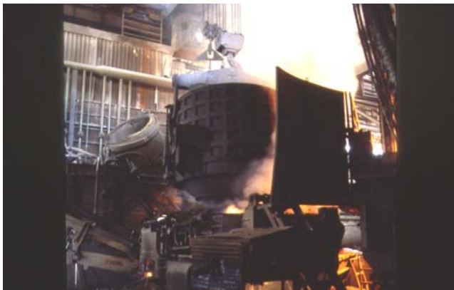
Figura 3.4.7. Posizionamento della cesta sopra il forno. Figura 3.4.8. Apertura delle valve e caduta del rottame
