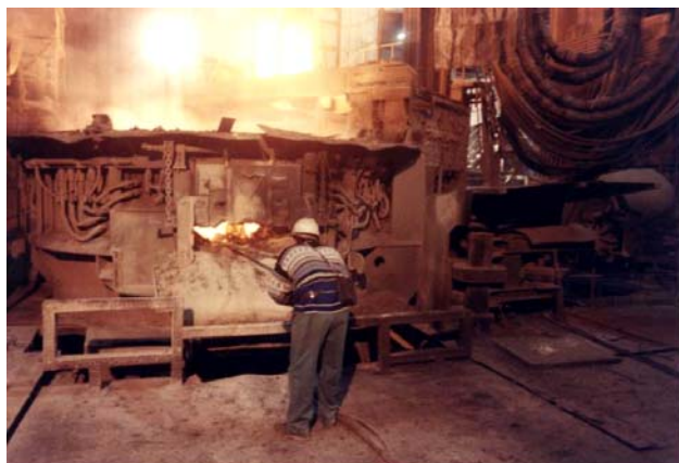
Figura 3.4.9. Spillaggio dell'acciaio. Figura 3.4.10. Spruzzaggio di polvere refrattaria tramite lancia
