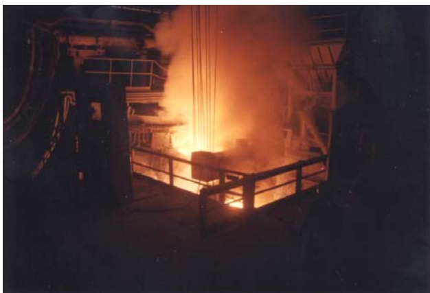
Figura 3.4.9. Spillaggio dell'acciaio. Figura 3.4.10. Spruzzaggio di polvere refrattaria tramite lancia
