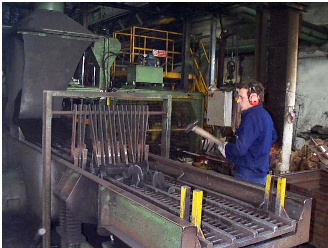
Fig. 3.12.11 Rottura con la mazza delle materozze sul trasportatore grigliato vibrante all'uscita della distaffatura dei getti provenienti dalla linea di formatura automatica . Il trasportatore è posto ad una altezza tale da permettere all'addetto di mantenere la posizione eretta durante la lavorazione.
