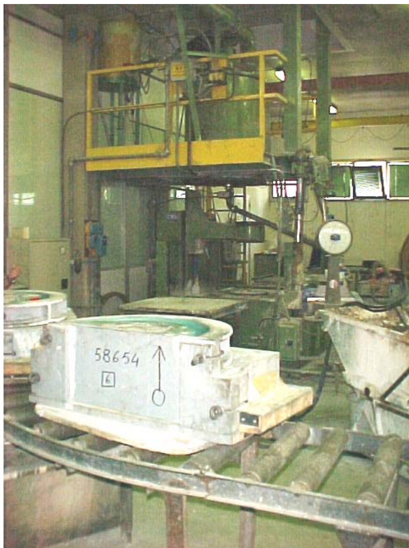
Fig. 3.6.1 Reparto formatura anime in ceramica. In primo piano una cassaforma sulla rulliera di movimentazione. Sullo sfondo il mescolatore (in alto) e la macchina per il riempimento delle casse d'anima (sotto).
