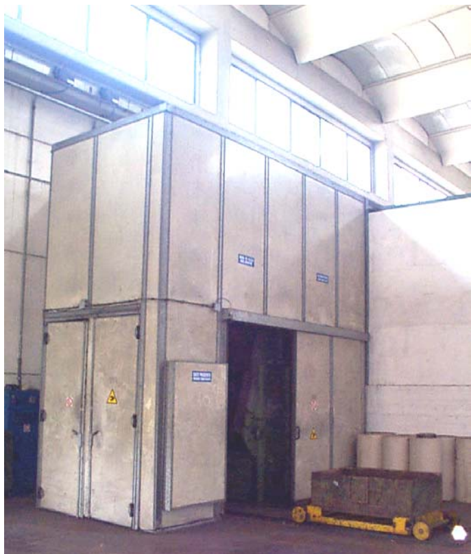
Fig. 3.13.4 A/B Cabinatura integrale della granigliatrice a tappeto.
