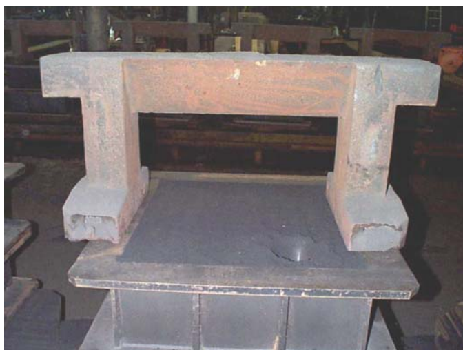
Fig. 3.10.11 Staffa piccola con sopra il peso per controbilanciare la forza metallostatica. Si noti il foro di colata nella forma.
