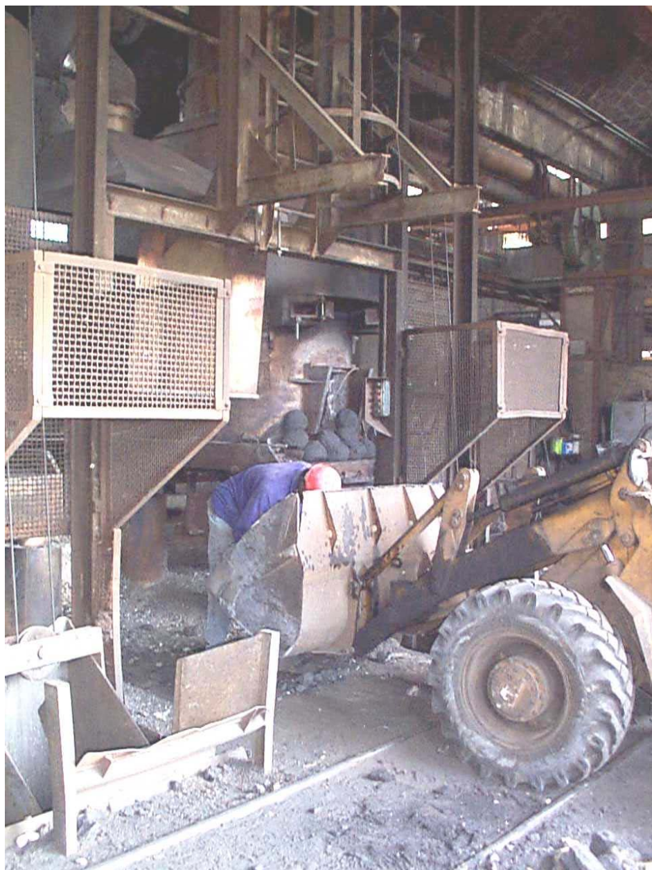
Fig. 3.11.1 Rifacimento quotidiano del refrattario del cubilotto : un addetto preleva dalla pala meccanica la terra refrattaria facendone delle palle con le mani e le porge ad un altro addetto che si trova dentro il cubilotto .
