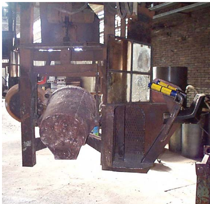
Fig. 3.10.17 A/B: Postazione schermata di colata sollevata dal pavimento essendo appesa su monorotaia. A: vista dal lato di colata . B: vista dal lato del sedile per l'operatore; si noti il coperchio mobile sulla siviera .
