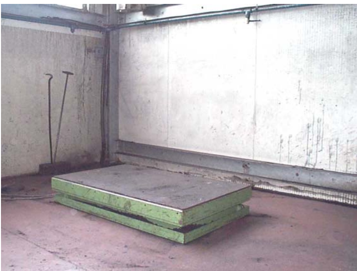
Fig. 3.4.4 Piattaforma per sollevare piccole staffe durante la formatura manuale.
