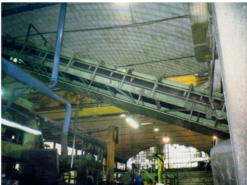
Fig. 3.2.3 Impianto a nastro sopraelevato per il trasporto della terra dalla miscelazione alla formatura.
