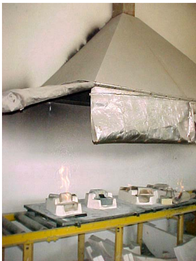
Fig. 3.6.12 Flambatura anime in ceramica sotto aspirazione.
