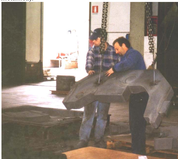
Fig. 3.12.9 Movimentazione meccanica di un pezzo distaffato.
