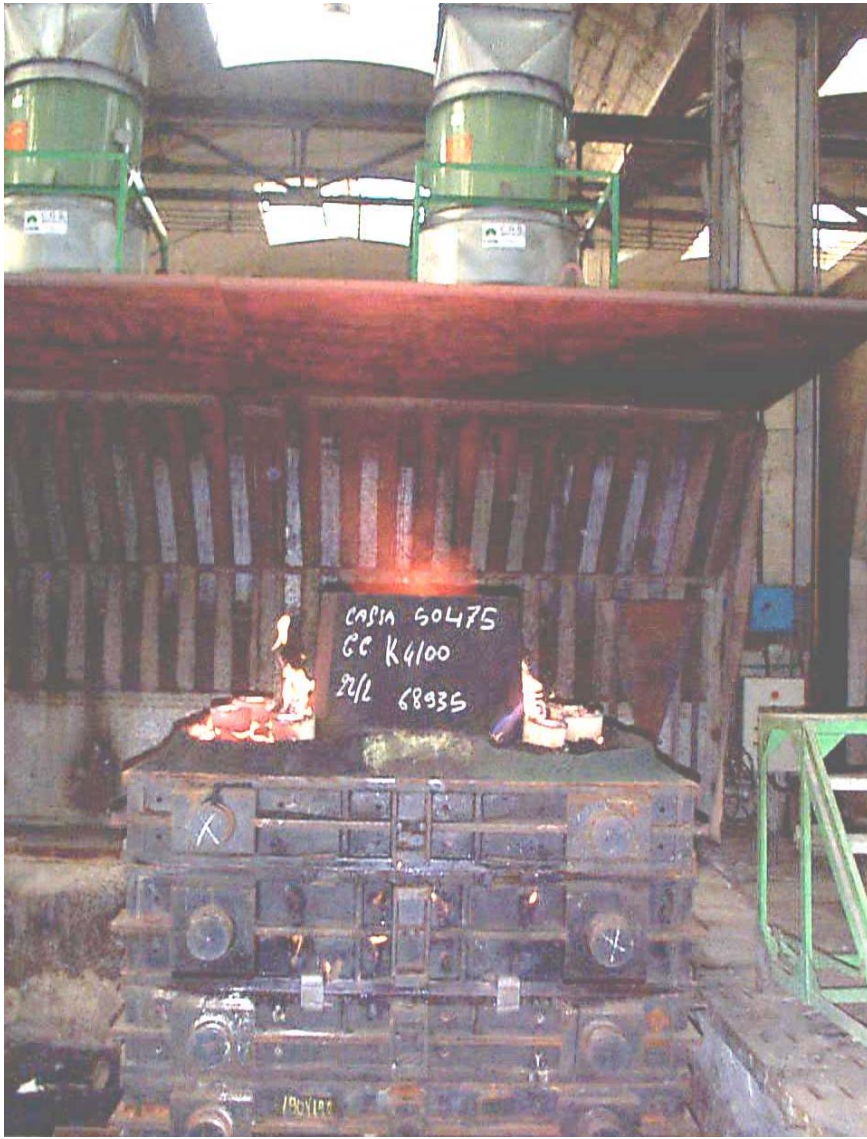
Fig. 3.10.18 Impianto di aspirazione con cappa mobile abbassata su una staffa di grandi dimensioni proveniente dalla linea di formatura manuale a resina .
