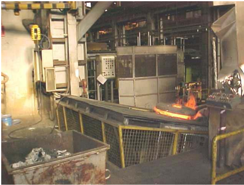
Fig. 3.9.23 (A, B, C) Forni fusori ad induzione in fase di sollevamento per la spillata del metallo fuso, visti dalla piattaforma sovrastante i forni stessi. Si notino: la protezione a griglia mobile contro il rischio di caduta dalla piattaforma nel vano del forno; le postazioni schermate per l'operatore che manovra il movimento dei forni; il cassone di raccolta delle scorie appoggiato sulla piattaforma.
