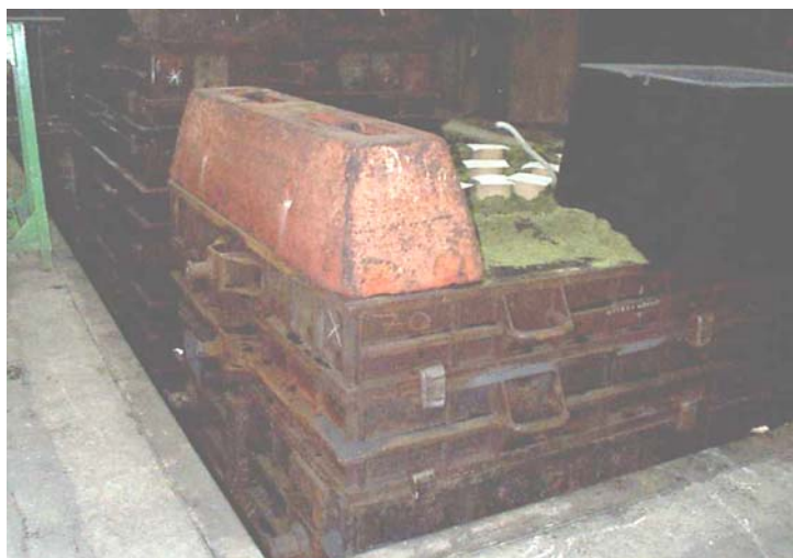
Fig. 3.10.10 Staffa grande chiusa con grappe e con sopra il peso per controbilanciare la forza metallostatica.
