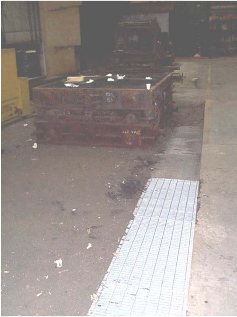
Fig. 3.10.13 Delimitazione zona di colata con pavimento grigliato.
