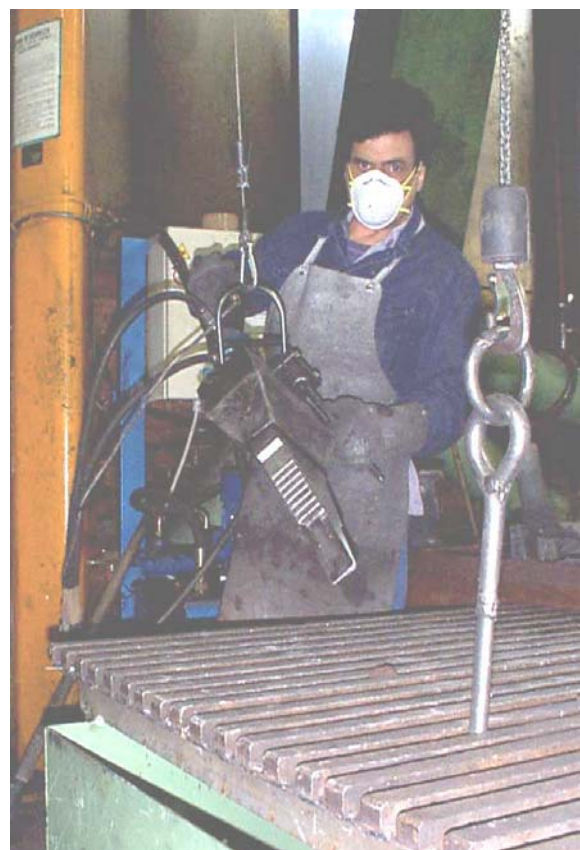
Fig. 3.12.8 Addetto alla smaterozzatura con smaterozzatrice a cuneo .
