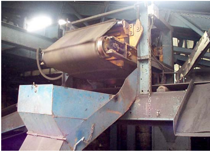
Fig. 3.2.4 Deferrizzatore ortogonale al nastro trasportatore; in primo piano lo scivolo di raccolta del metallo.
