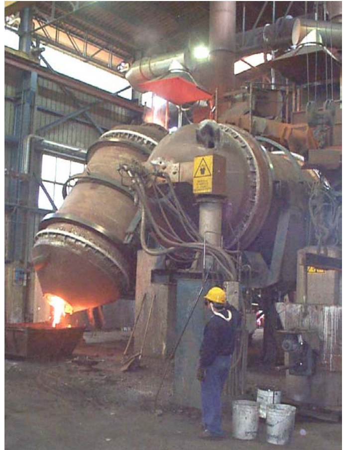
Fig. 3.9.15 Due forni rotativi di cui uno in fase di scorifica entro un cassone metallico.
