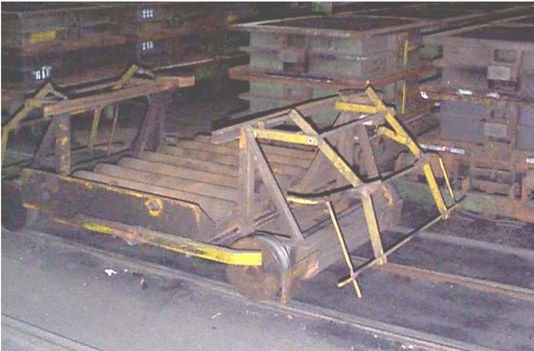
Fig. 3.3.2 Carrellino su rotaia per la movimentazione automatica delle staffe .
