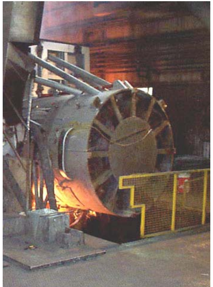
Fig. 3.9.23 (A, B, C) Forni fusori ad induzione in fase di sollevamento per la spillata del metallo fuso, visti dalla piattaforma sovrastante i forni stessi. Si notino: la protezione a griglia mobile contro il rischio di caduta dalla piattaforma nel vano del forno; le postazioni schermate per l'operatore che manovra il movimento dei forni; il cassone di raccolta delle scorie appoggiato sulla piattaforma.
