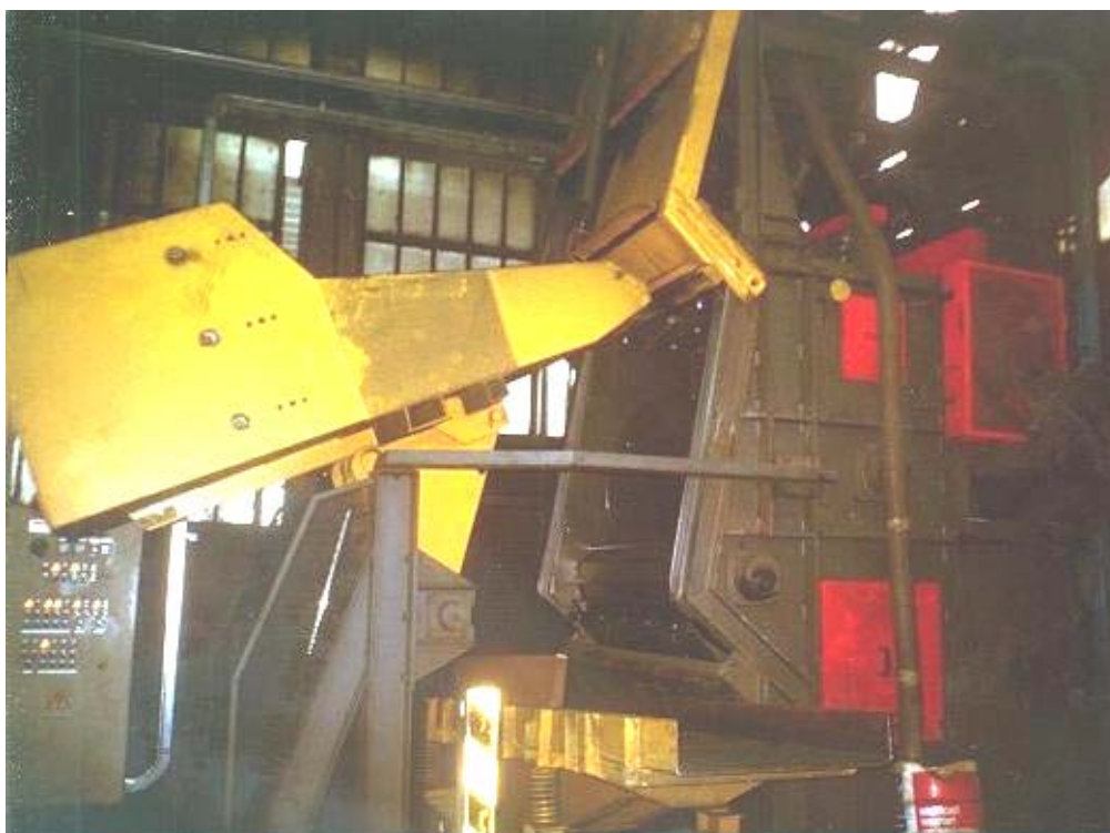
Fig. 3.13.1 Sabbiatrice a tappeto durante il caricamento dei getti . Si noti il caricatore automatico a sollevamento pneumatico (giallo a sinistra) ed il coperchio scorrevole aperto (giallo in alto).
