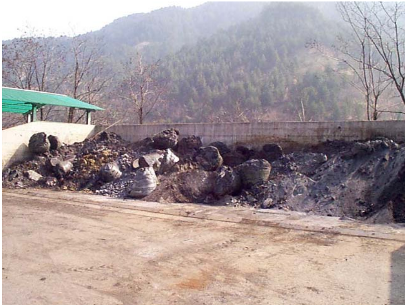
Fig. 4.1.1 Stoccaggio temporaneo esterno delle scorie di fusione con forni a cubilotto.
