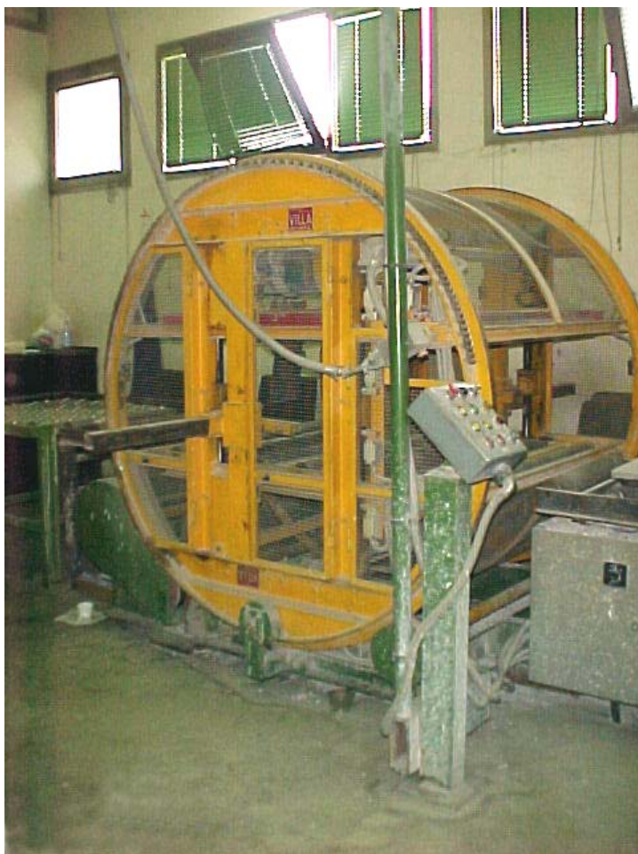
Fig. 3.6.11 Protezione sul sistema di ribaltamento delle casce d'anima per la produzione di anime in ceramica.
