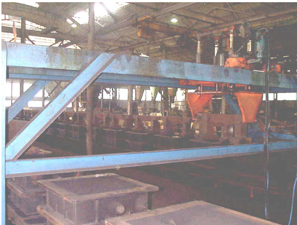
Fig. 3.10.12 Impianto automatico per la movimentazione dei pesi per controbilanciare la forza metallostatica, in una linea di formatura automatica.
