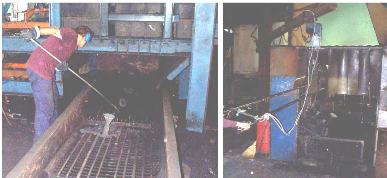
Fig. 3.12.4 Prelevamento dei pezzi dalla griglia vibrante all'uscita della distaffatura: A) tramite pinza pneumatica sostenuta da un paranco; B) tramite un'asta di acciaio con la punta ricurva.
