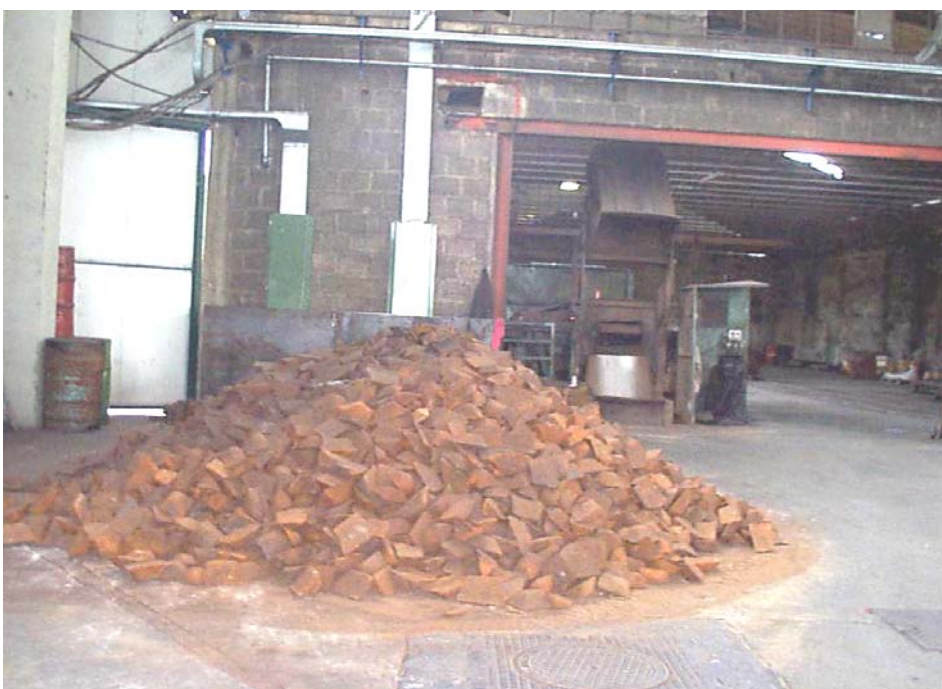
Fig. 3.9.5 Pani di ghisa in attesa del caricamento in forno. Sullo sfondo il caricatore ribaltabile del forno.
