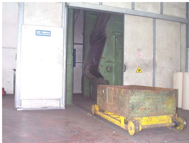
A: particolare del carrellino su rotaia per l'estrazione dei getti trattati dalla granigliatrice a tappeto cabinata.
