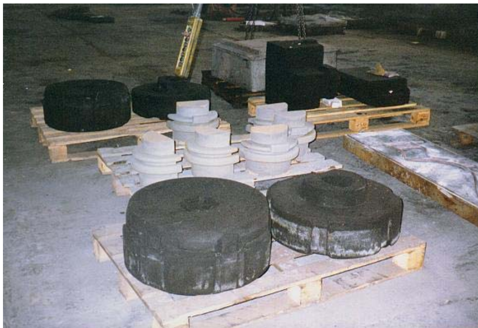
Fig. 3.6.2 Anime di varie dimensioni appoggiate su pancali di legno per la loro movimentazione con il carrello elevatore .
