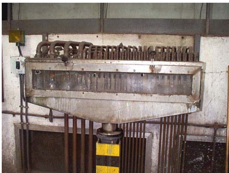
Fig. 3.9.21 Sistema di controllo visivo del circuito idrico di raffreddamento di un forno fusorio a induzione.
