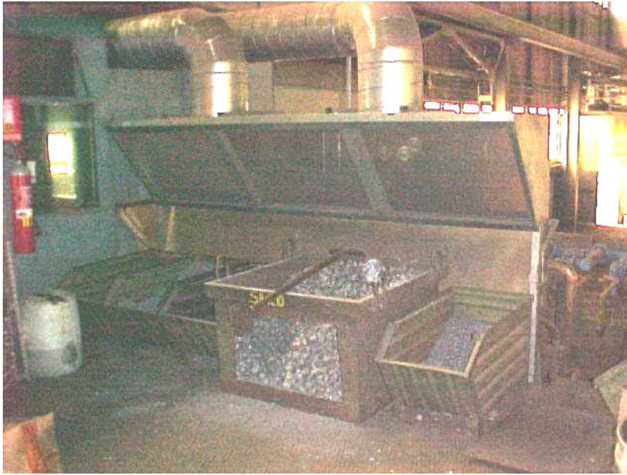
Fig. 3.9.20 Impianto di aspirazione sui materiali utilizzati come correttivi della fusione (posizionati sopra la piattaforma dei forni elettrici a induzione).
