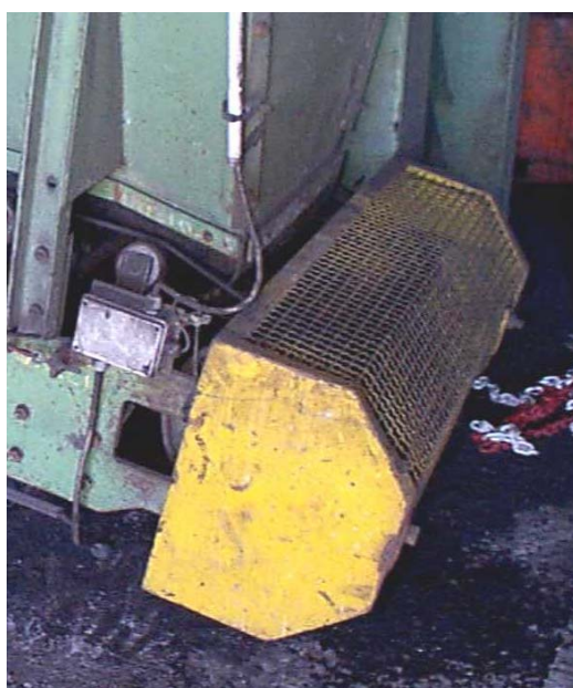
Fig. 3.2.6 Filo di sicurezza lungo il nastro trasportatore collegato al dispositivo di arresto di emergenza.
