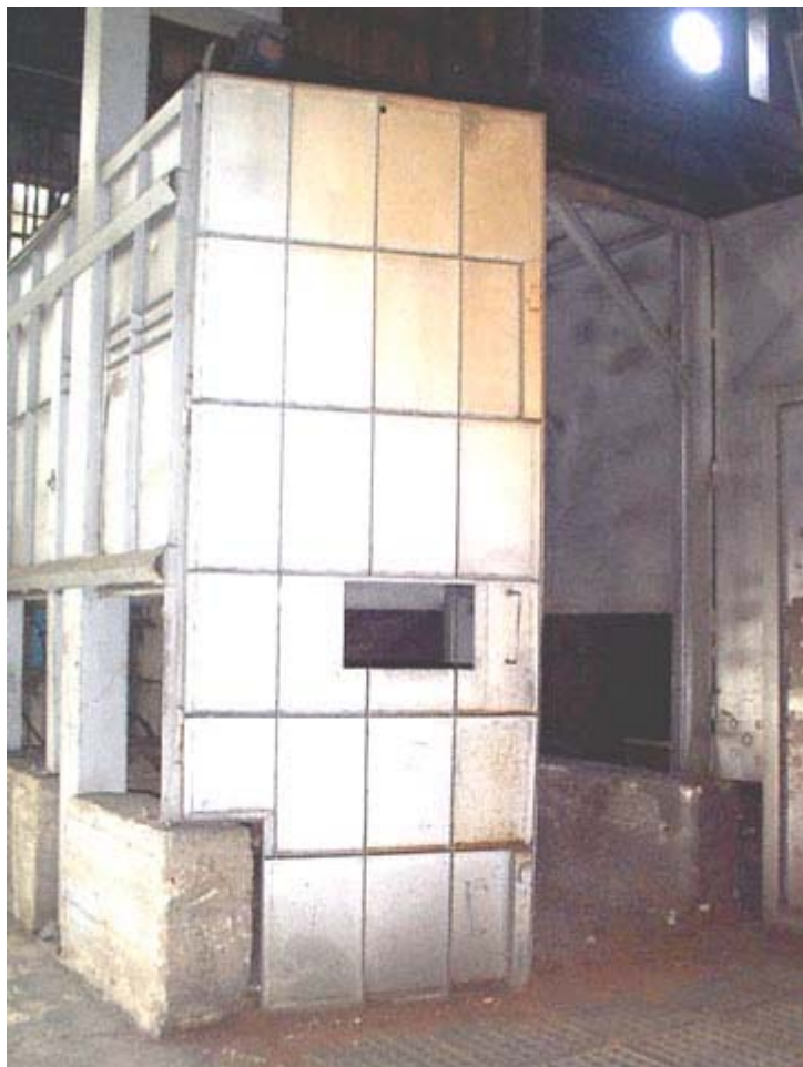
Fig. 3.9.16 Cabina per l'aspirazione dei fumi dalla siviera durante la produzione di ghisa sferoidale.
