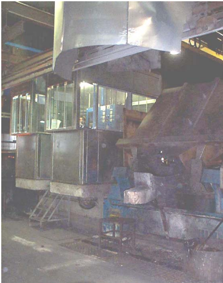
Fig. 3.9.18 Forno elettrico con cappa di aspirazione localizzata e postazione di comando e controllo cabinata.
