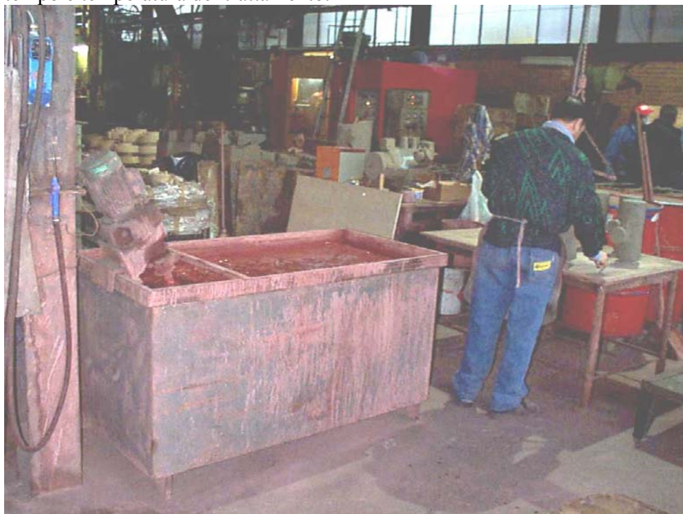
Fig. 3.7.1 Vasca di verniciatura delle anime con vernici refrattarie all'acqua, dotata di mescolatore.
