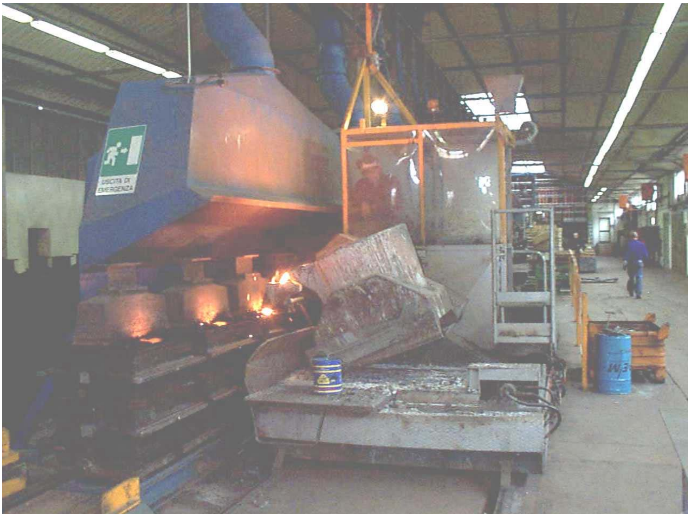
Fig. 3.10.16 Colata dalla siviera nelle forme tramite il carro di colata , alla linea di stafte preparate con sistema di formatura automatica.
