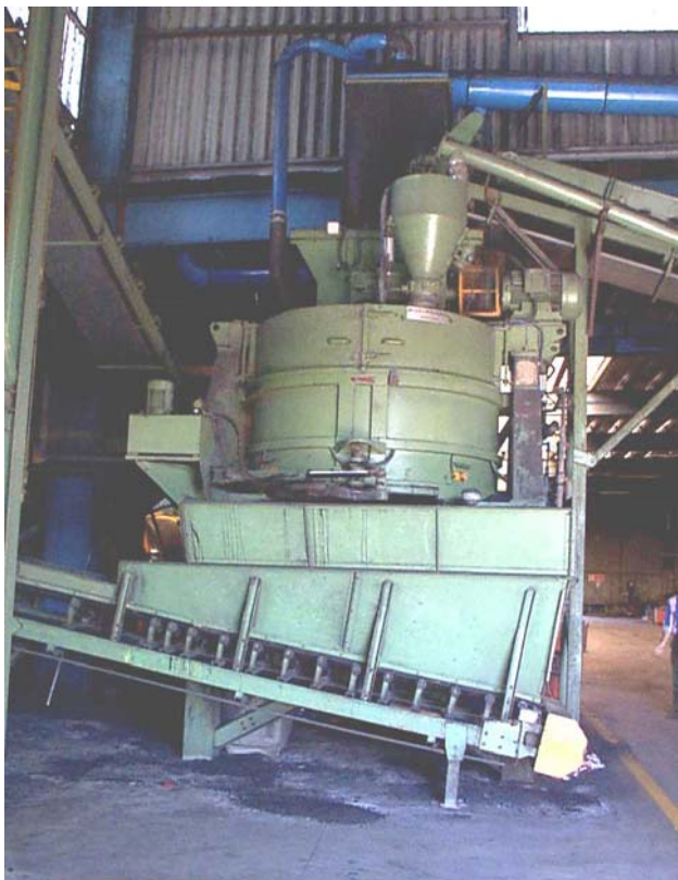
Fig. 3.2.1 Macchina molazzatrice : vista d'insieme.
