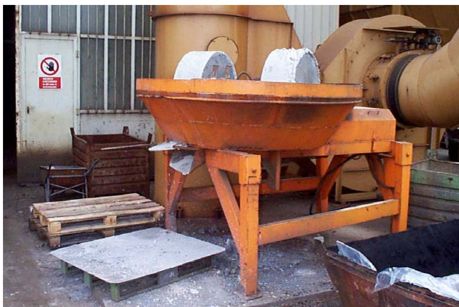
Fig. 3.11.2 Molazza per la preparazione della terra refrattaria (macchina con protezioni rimosse).
