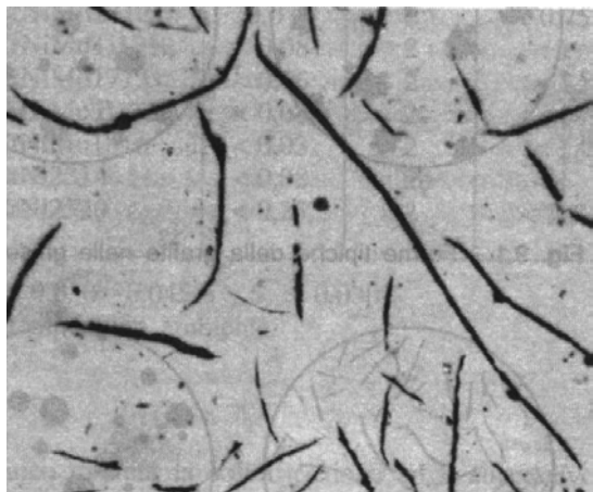
Fig. 3.9.1 Ghisa grigia a grafite lamellare (ingrandimento: 300 x)
