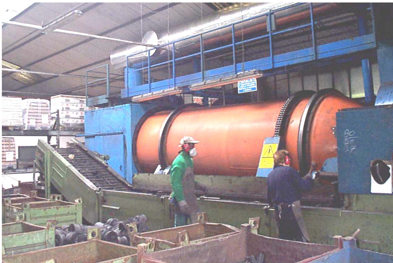
Fig. 3.12.3 Prelevamento dei getti prodotti distaffati dalla linea automatica e usciti dal disterratore a tamburo rotante (posto sotto aspirazione). Gli addetti rompono le materozze con la mazzetta e recuperano getti e materozze dal trasportatore corrugato che è posto ad una altezza tale da permettere agli addetti di mantenere la posizione eretta.
