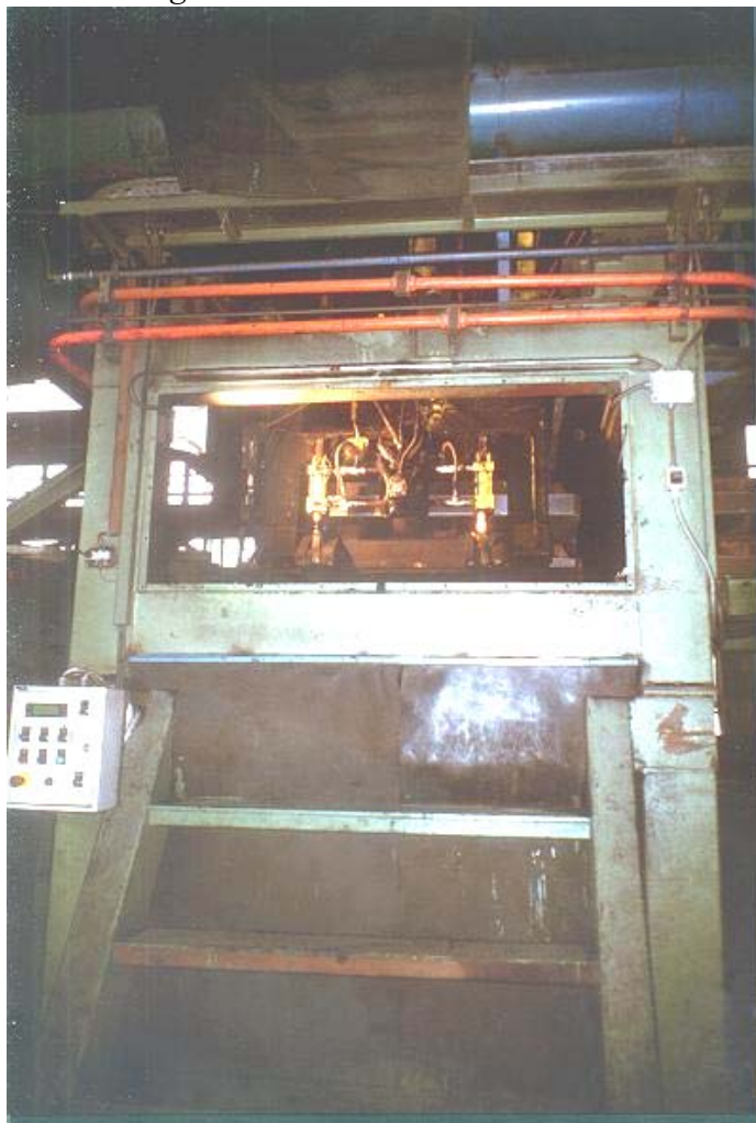
Fig. 3.12.1 Distaffatore linea automatica chiamato pugno .
