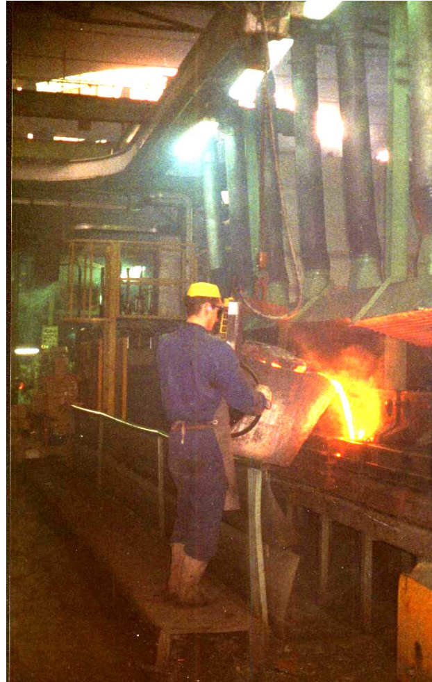
Fig. 3.10.3 Colata dalla siviera nella forma . Si noti la monorotaia (in alto), la pulsantiera di comando (gialla) per la movimentazione della siviera , il volante manovrato manualmente dall'operatore per inclinare la siviera e le cappe di aspirazione localizzata (verde).
