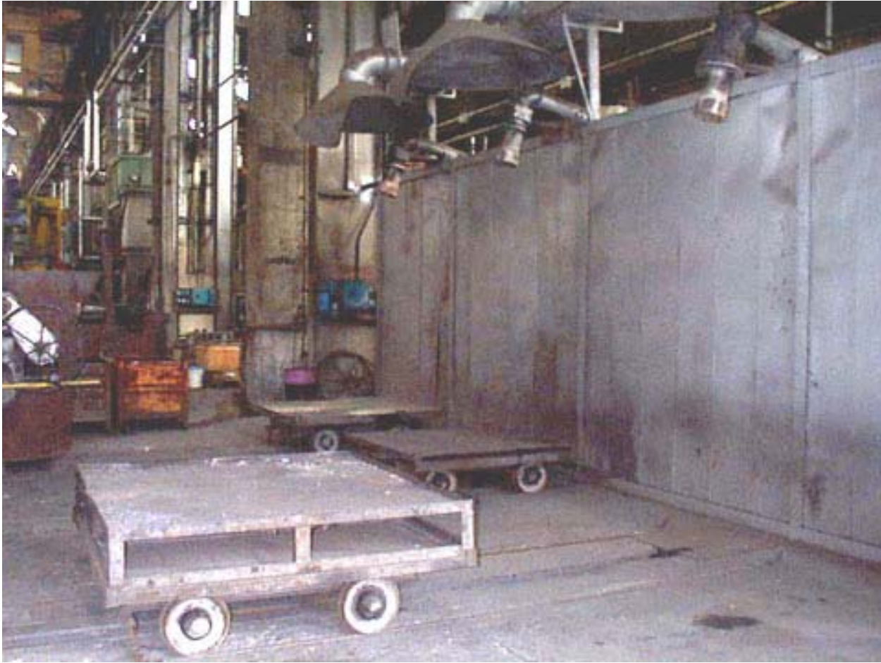
Fig. 3.11.5 Carrelli per la movimentazione di siviere da porre sotto l'impianto di trattamento termico.
