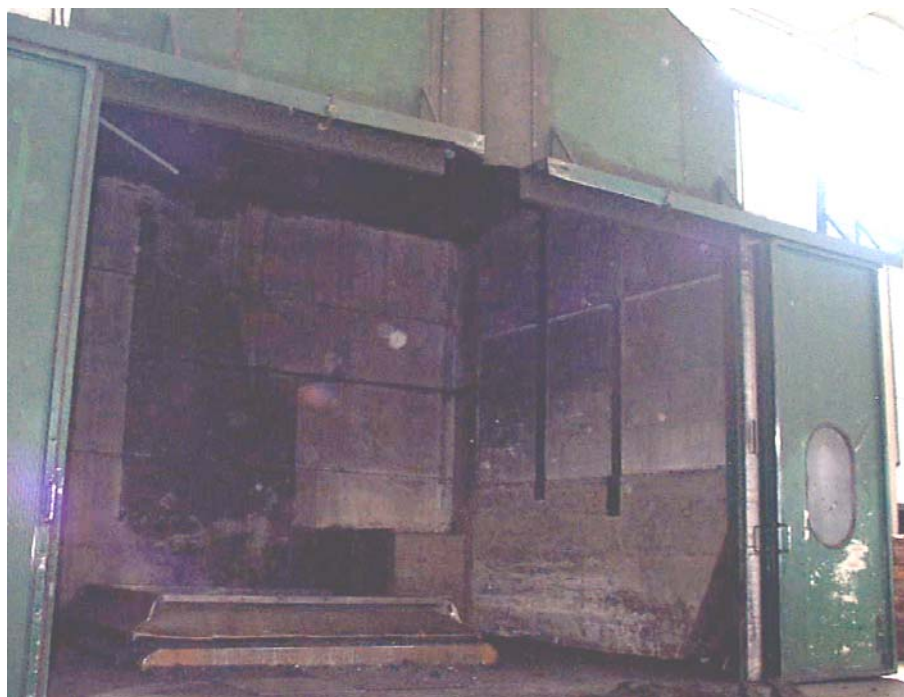
Fig. 3.12.6 Griglia vibrante distaffatrice per staffe grandi, segregata tramite cabina insonorizzata.
