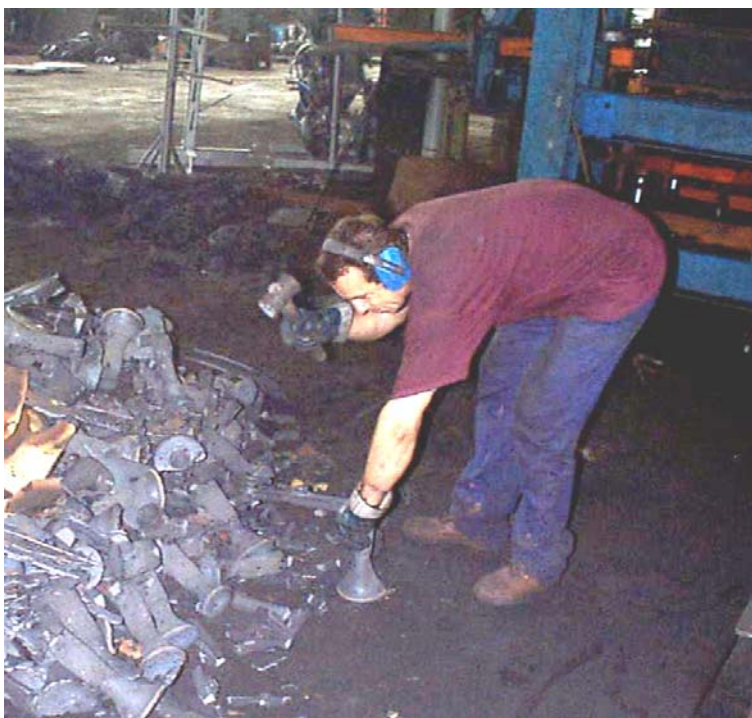
Fig. 3.12.10 Rottura manuale delle materozze di pezzi piccoli in una azienda caratterizzata da una produzione limitata.
