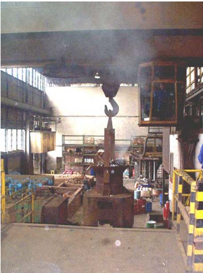
Fig. 3.9.6 Forno a gas per il preriscaldamento del rottame.
