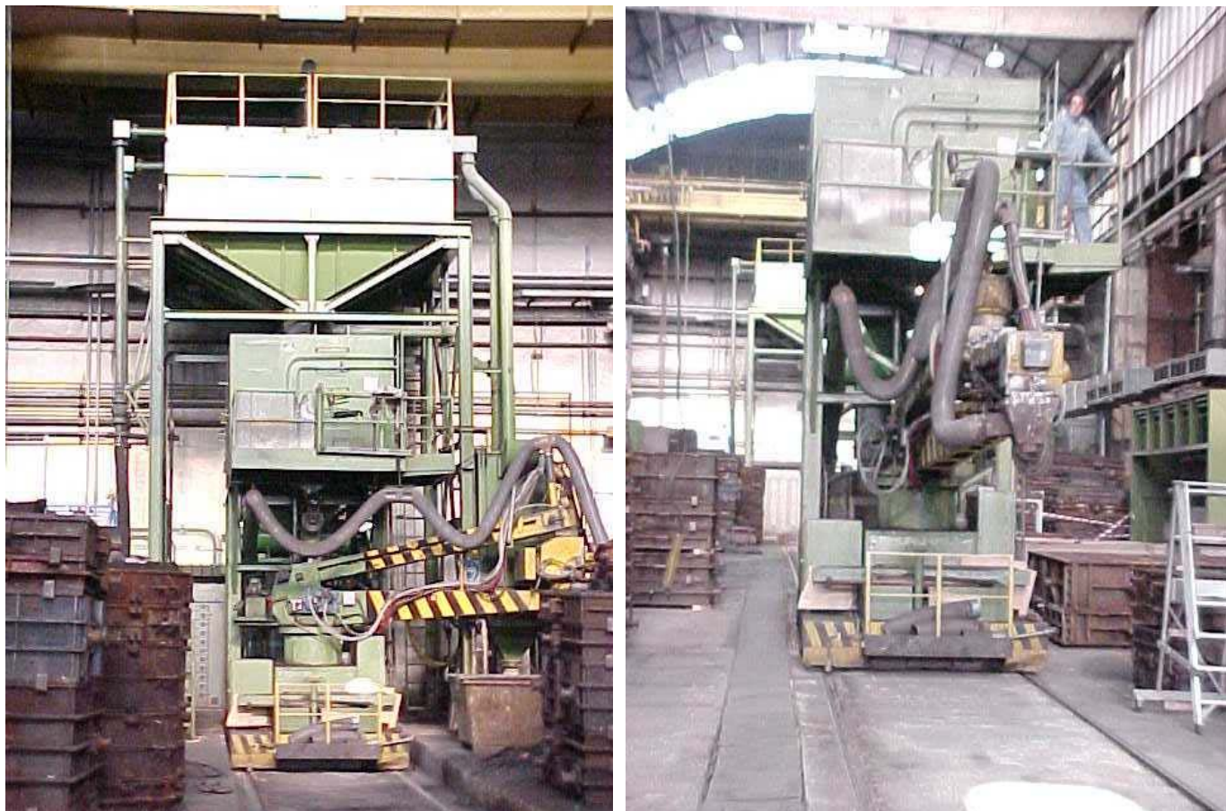
Fig. 3.4.2 A/B: Carro su rotaia (chiamato in gergo cammello ) con braccio mobile per riempimento delle staffe grandi con terra di fonderia nel reparto di formatura manuale (Fig. A: in posizione di carico dalla tramoggia; Fig. B: in posizione di scarico nelle staffe , con operatore a bordo).
