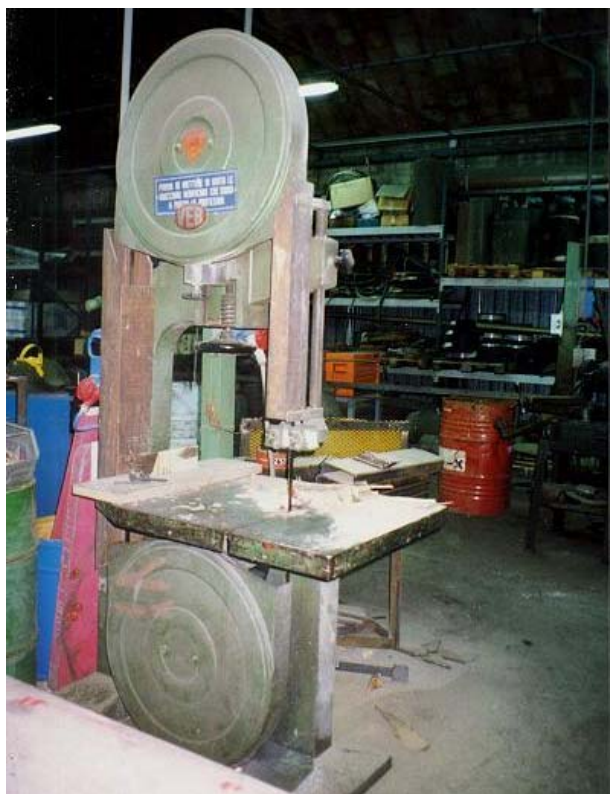
Fig. 3.1.2 Sega a nastro per la riparazione dei modelli .
