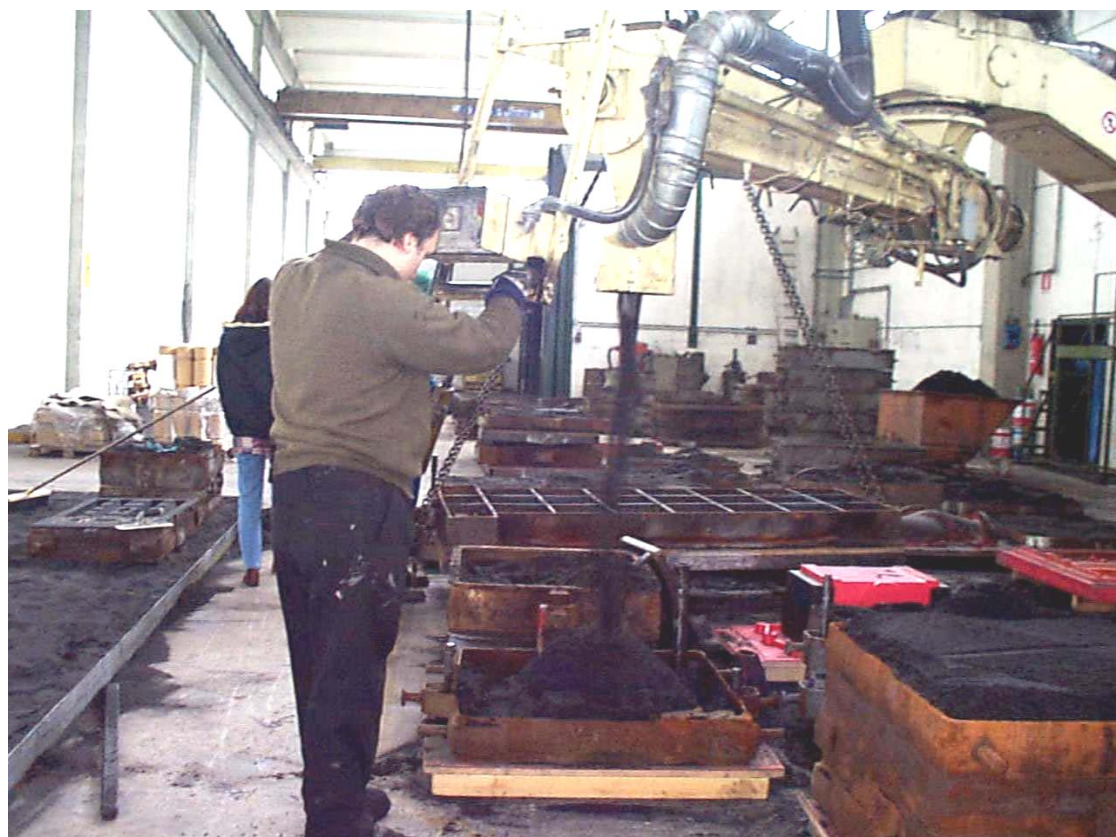
Fig. 3.4.1 Riempimento staffe con terra di fonderia nel reparto di formatura manuale con impianto fisso. Si noti il tubo di colore grigio argenteo per l'aspirazione localizzata sulla bocca di uscita della terra dal mescolatore a coclea.
