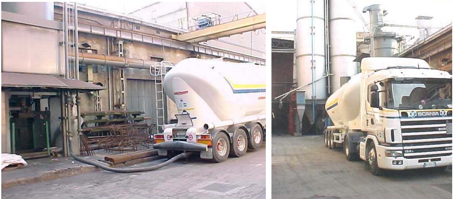
Fig. 3.2.12 A/B. Camion autocisterna che carica i silos di sabbia silicea in modo pneumatico senza diffusione di polveri.
