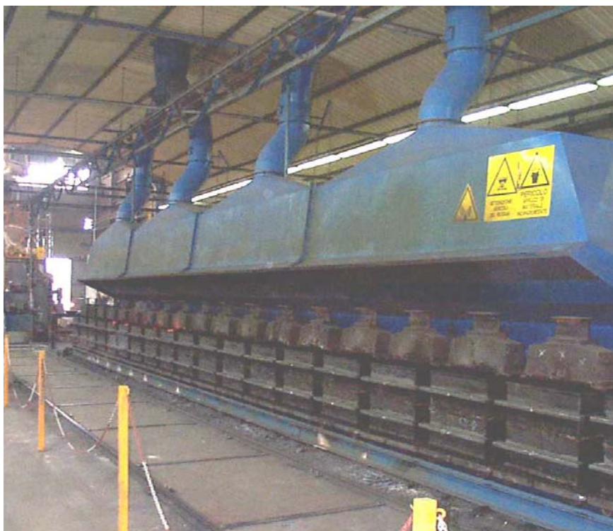
Fig. 3.10.19 Impianto di aspirazione su linea di colata nelle forme realizzate con un impianto formatura automatica a verde .
