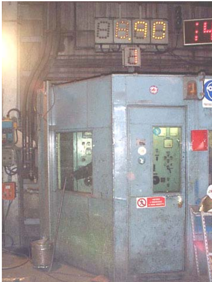
Fig. 3.9.24 Particolare della cabina climatizzata e insonorizzata dove stazionano gli addetti alla sorveglianza del funzionamento dei forni elettrici a induzione.
