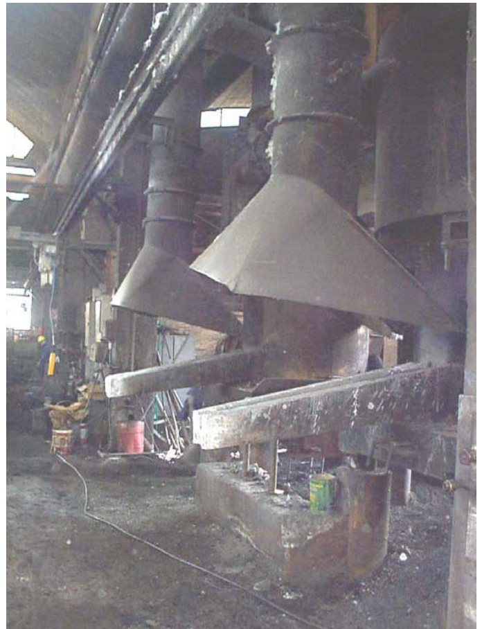
Fig. 3.9.19 Cappe di aspirazione alle bocche di spillata di due forni a cubilotto affiancati.
