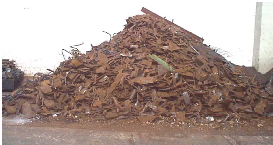
Fig. 3.9.4 Rottame di ghisa in attesa del caricamento in forno.
