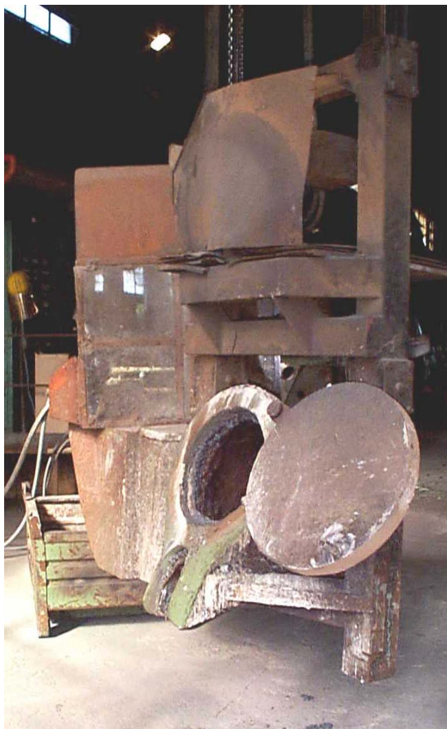
Fig. 3.10.17 A/B: Postazione schermata di colata sollevata dal pavimento essendo appesa su monorotaia. A: vista dal lato di colata . B: vista dal lato del sedile per l'operatore; si noti il coperchio mobile sulla siviera .
