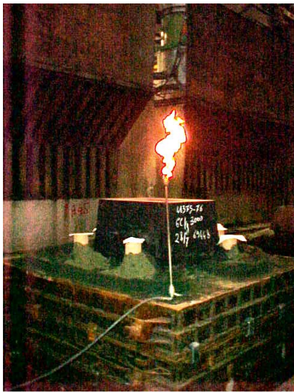
Fig. 3.7.2 Flambatore acceso appoggiato su una staffa.
