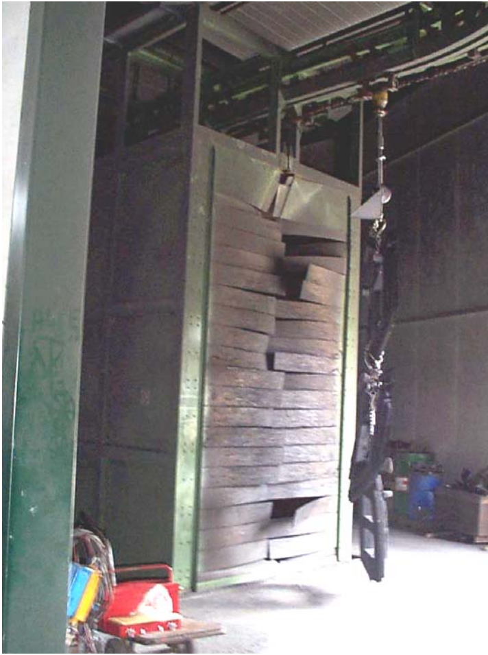
Fig. 3.13.2 Introduzione automatica nella sabbiatrice a tunnel dei getti appesi al paranco.
