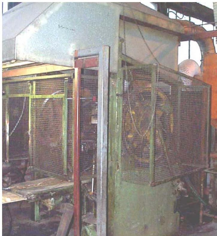
Fig. 3.6.3 Protezioni a griglia metallica degli organi in movimento su macchina spara anime di tipo vecchio.
