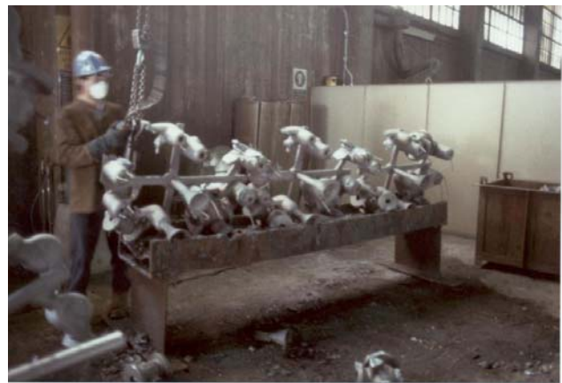
Figura 3.8.6. Posizionamento dei getti su banco per effettuare il taglio materozze
