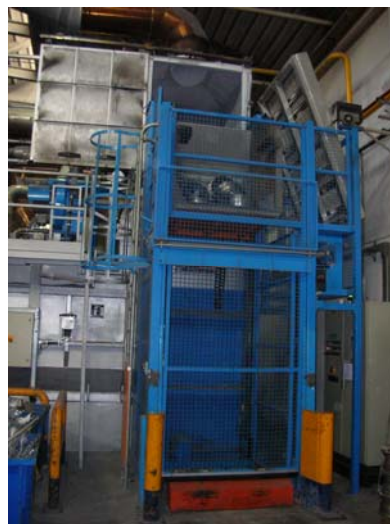
Figura 3.3.2. Caricamento di forno a tino mediante elevatore meccanico
