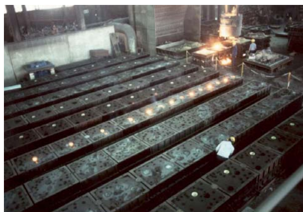
Figura 3.7.2. Colata in forme refrattarie allineate dopo formatura automatica in linea a carosello
