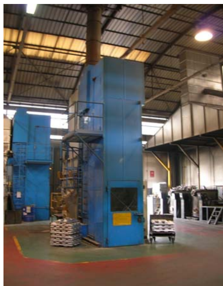
Figura 3.3.10. Forno fusorio a tino per leghe di alluminio con condotto espulsione fumi aspirati
