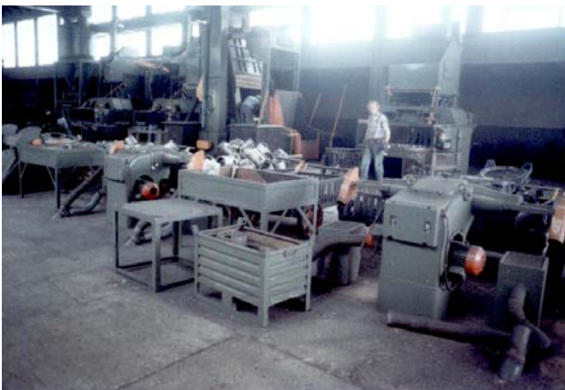
Figura 3.9.2. Impianti di molatura a banco, operazioni di movimentazione manuale dei getti
