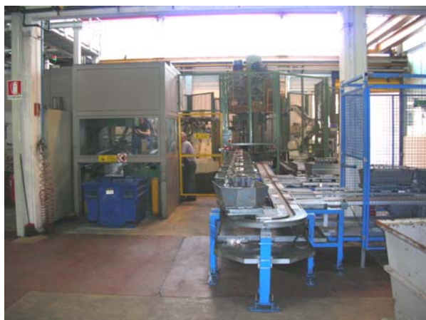
Figura 3.8.13. Macchina sterratrice per getti in ghisa. Intervento di disincaglio della colcea
