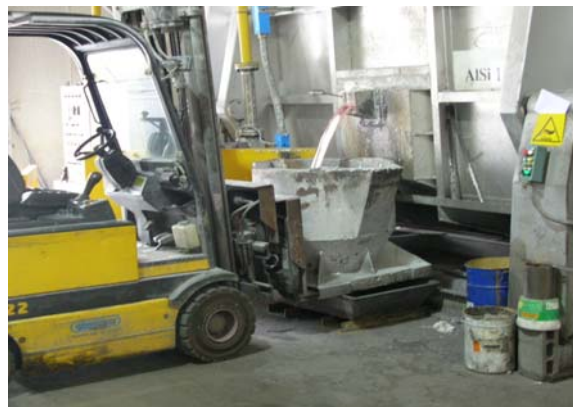
Figura 3.3.5. Alimentazione di forno a crogiolo di attesa tramite canale Figura 3.3.6. Alimentazione di forno a crogiolo di colata tramite siviera
