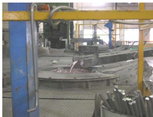
Figura 3.3.5. Alimentazione di forno a crogiolo di attesa tramite canale Figura 3.3.6. Alimentazione di forno a crogiolo di colata tramite siviera
