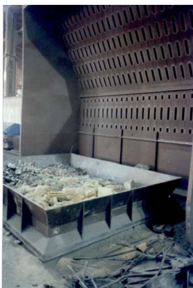
Figura 3.8.14. Griglia vibrante di distaffatore presidiata da aspirazione Figura 3.8.15. Macchina sterratrice robotizzata posta in cabina insonorizzata
