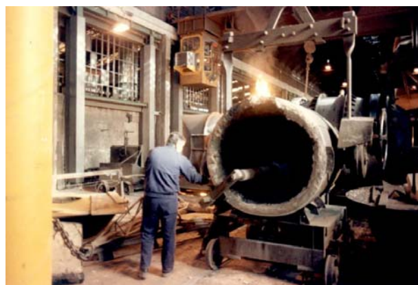
Figura 3.3.7. Trattamento di sferoidizzazione della ghisa con magnesio Figura 3.3.8. Ripristino della siviera con scaricatore ad asta e tuffante
