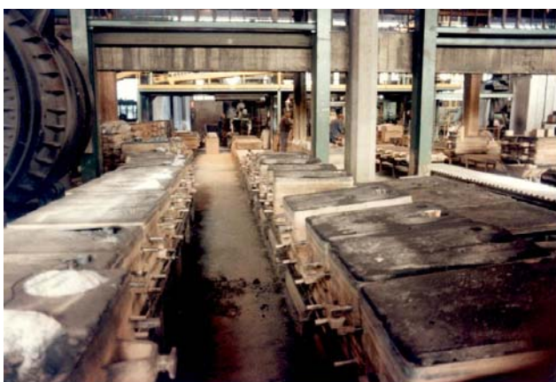
Figura 3.7.2. Colata in forme refrattarie allineate dopo formatura automatica in linea a carosello
