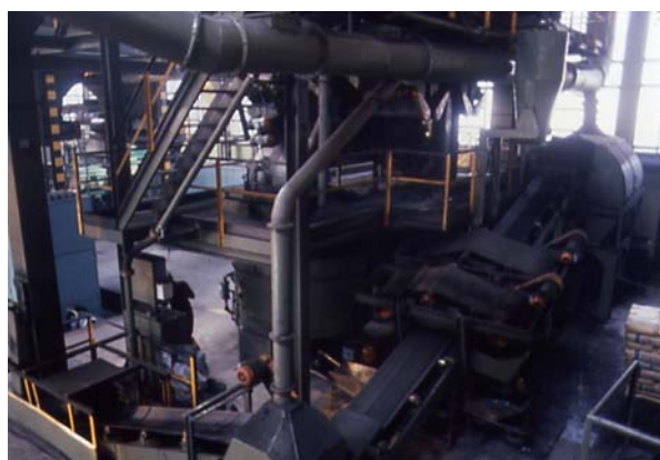
Figura 3.5.2. Impianto preparazione terre. Condotti di aspirazione dei nastri di raccolta e trattamento terre
