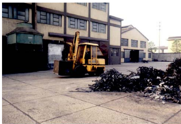
Figura 3.2.4. Parco rottame pavimentato: movimentazione del rottame di carica con carrello e cassone
