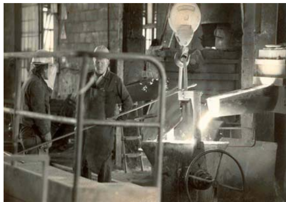
Figura 3.3.3. Spillaggio da cubilotto a siviera Figura 3.3.4. Spillaggio da forno a riverbero a siviera su carrello
