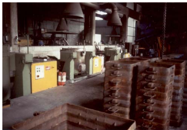
Due forni a crogiolo per la preparazione di leghe non ferrose (in primo piano le staffe delle forme in sabbie refrattarie)
