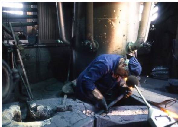
Figura 3.11.2. Ripristino rivestimento refrattario di usura di un canale di colata di forno a crogiolo
