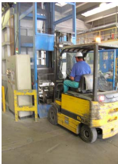
Figura 3.3.2. Caricamento di forno a tino mediante elevatore meccanico
