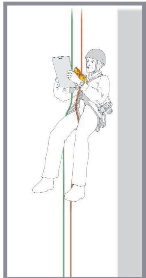
per mezzo del discensore, controllando che il dispositivo anticaduta mobile scorra liberamente sulla fune di sicurezza.
