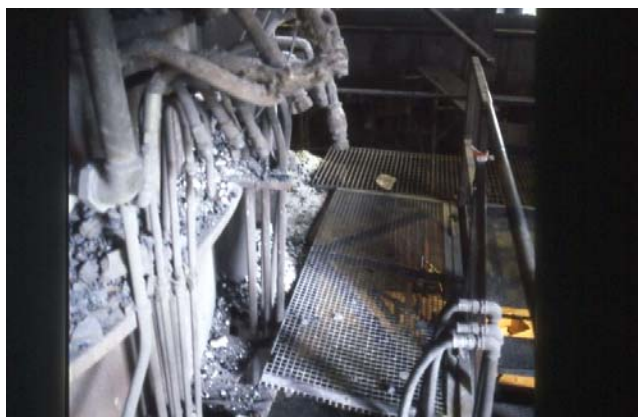
Figura 1. Forno elettrico ad arco. Intervento di manutenzione agevolato dalla presenza di specifica piattaforma Figura 2. Forno elettrico ad arco. Intervento di manutenzione richiesto da perdita dei circuiti di raffreddamento
