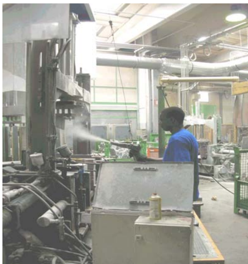
Figura 3.7.11. Isola di stampaggio in conchiglia posta sotto aspirazione, le bandelle in plastica consentono un efficace convogliamento del flusso d'aria. Figura 3.7.12. Cappa di aspirazione a servizio di isola di pressocolata
