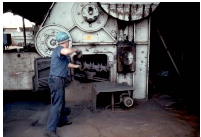
Figura 3.8.13. Macchina sterratrice per getti in ghisa. Intervento di disincaglio della colcea
