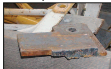
Foto. n. 11 Piastra metallica per l'ancoraggio allo scafo
