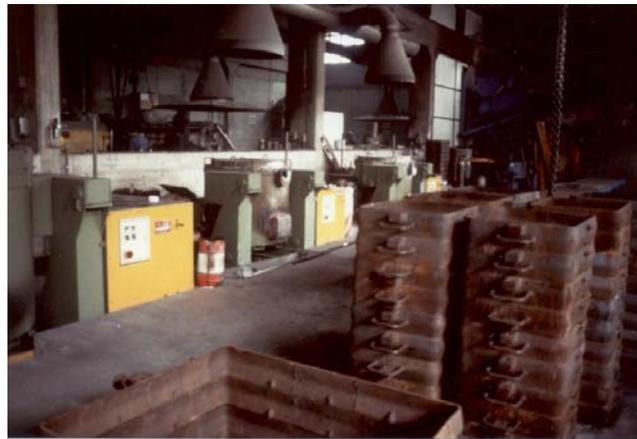
Due forni a crogiolo per la preparazione di leghe non ferrose
