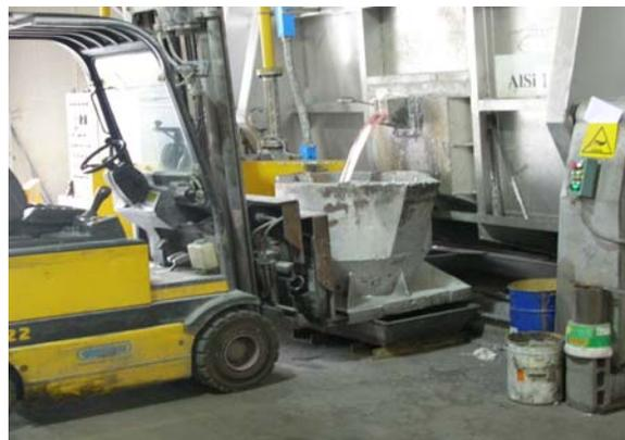
**Figura 3.3.5. Alimentazione di forno a crogiolo di attesa tramite canale**
