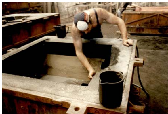
Figura 3.6.2. Formatura manuale di terre a verde: verniciatura manuale
