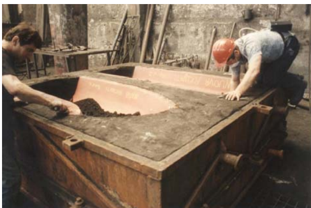
Figura 3.6.2. Formatura manuale di terre a verde: verniciatura manuale
