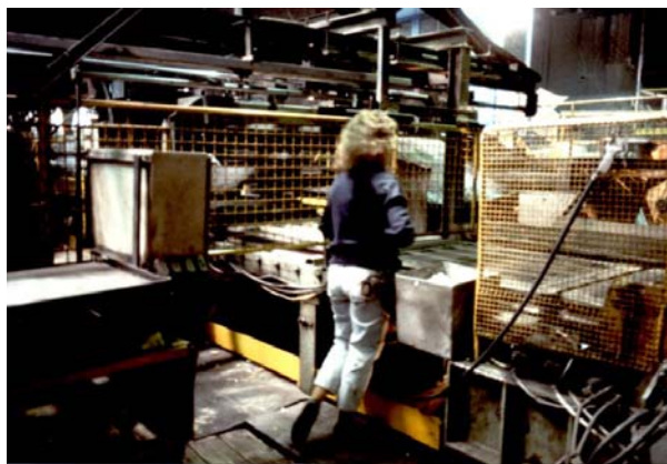
Figura 3.6.11. Formatura in linea automatizzata. Linea e nastri distribuzione terre alle formatrici Figura 3.6.12. Formatura in linea automatizzata. Anime e posizioni di inserimento
