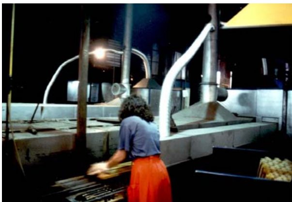
Figura 3.6.11. Formatura in linea automatizzata. Linea e nastri distribuzione terre alle formatrici Figura 3.6.12. Formatura in linea automatizzata. Anime e posizioni di inserimento
