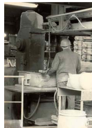
Figura 3.6.5. Formatura a macchina per vibroscossa Figura 3.6.6. Formatura a macchina per vibroscossa. Caduta di polveri da nastri sulle posizioni di lavoro
