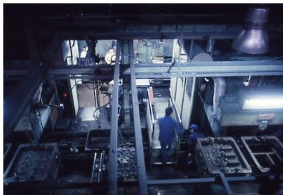
Figura 3.6.11. Formatura in linea automatizzata. Linea e nastri distribuzione terre alle formatrici Figura 3.6.12. Formatura in linea automatizzata. Anime e posizioni di inserimento
