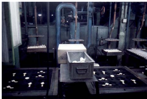
Figura 3.6.11. Formatura in linea automatizzata. Linea e nastri distribuzione terre alle formatrici Figura 3.6.12. Formatura in linea automatizzata. Anime e posizioni di inserimento
