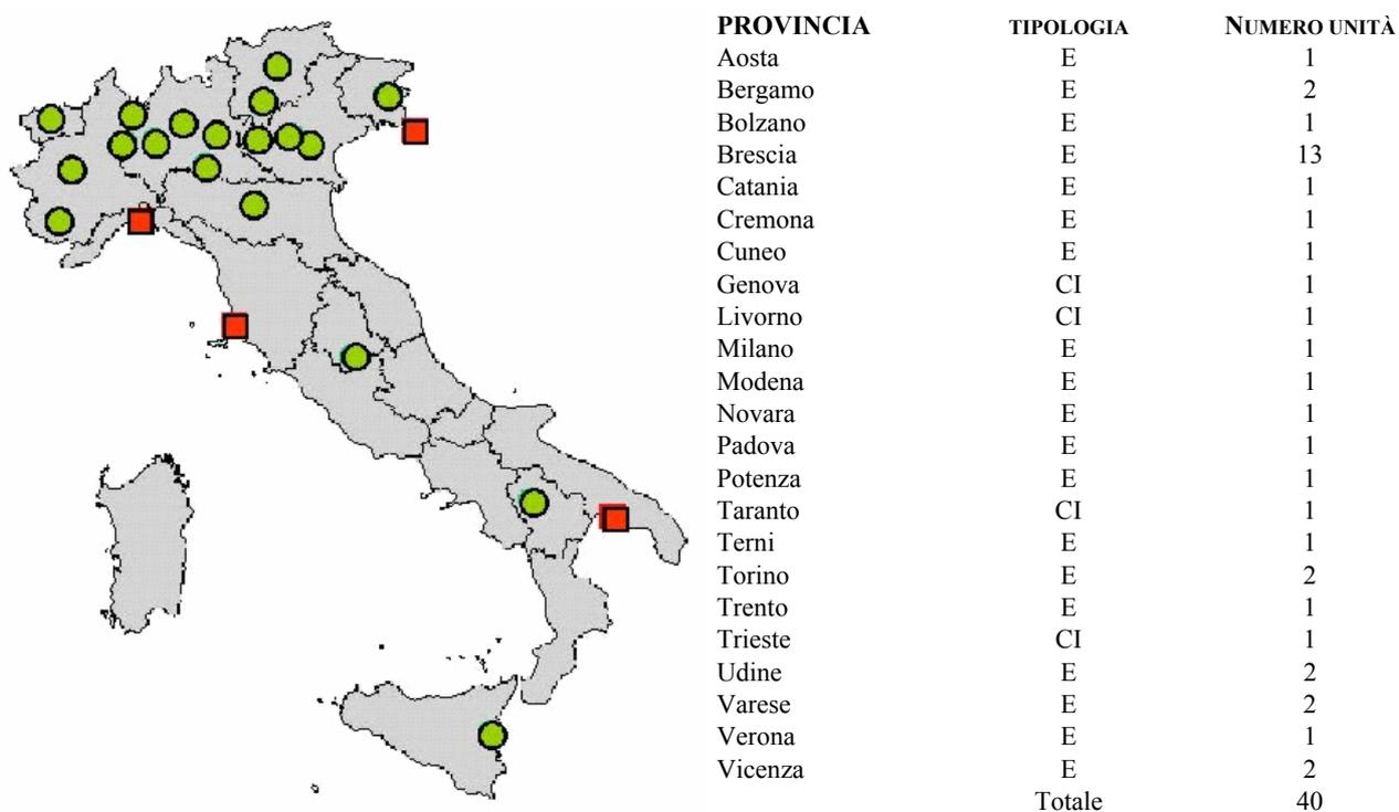
La localizzazione costiera delle acciaierie a ciclo integrale è dettata dall'elevata taglia richiesta agli impianti per la realizzazione di un'economia di scala e dalla necessità di favorire l'approvvigionamento delle materie prime (minerale ferroso e carbone) derivanti completamente dall'importazione.
