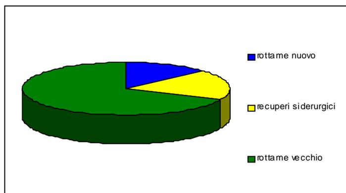
L'offerta di rottame per la siderurgia elettrica (Figura 1.7) deriva per un 10% dai recuperi siderurgici, per un 15% dal rottame nuovo e per un 75% dalla raccolta di rottame vecchio. Per rottame nuovo si intendono scarti delle lavorazioni meccaniche, con il termine rottame vecchio si indicano materiali provenienti da demolizione di impianti industriali, di navi, di materiale rotabile, di macchine e infrastrutture varie, raccolte in aree urbane e rurali.
