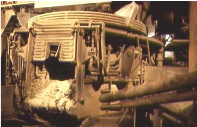
Figura 3.4.1. Forno elettrico ad arco, particolare delle porta e della carpenteria del tino a circolazione di acqua Figura 3.4.2. Rappresentazione schematica dei flussi riferiti a un forno ad arco
