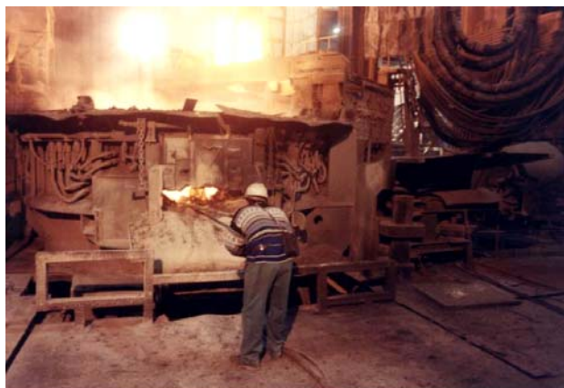
Figura 3.4.9. Spillaggio dell'acciaio. Figura 3.4.10. Spruzzaggio di polvere refrattaria tramite lancia
