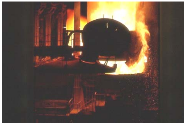
Figura 3.4.7. Posizionamento della cesta sopra il forno. Figura 3.4.8. Apertura delle valve e caduta del rottame
