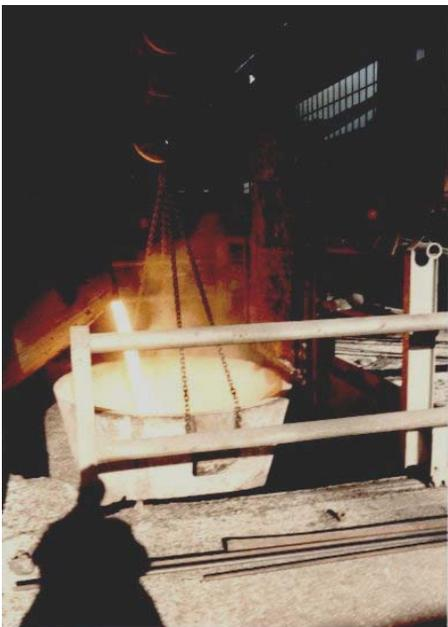
Paiola sostenuta dalle catene con tiro triangolare durante il travaso della scoria, travaso da completare con operazione di scorifica con raspa operando frontalmente dal ponte scorrevole
