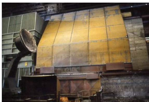
Figura 2.20. Dog-house chiusa, lato platea lavoro. Figura 4.21. Dog-house chiusa, lato spillaggio Figura 4.22. Dog-house aperta nella sezione inferiore durante affinazione Figura 4.23. Dog-house aperta nella sezione superiore (fase di carica e di spruzzaggio, come nell'immagine)
