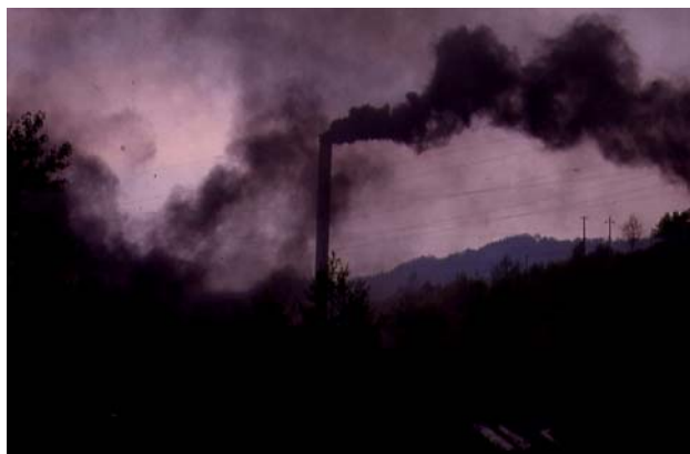
Figura 4.7. Visibili emissioni derivanti da forno di riscaldamento alimentato a olio combustibile Figura 4.8. Camini di forni di riscaldamento alimentati a gas naturale
