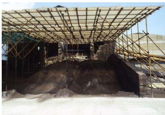
Figura 4.5. Precario accumulo di fumi di forno elettrico. Figura 4.6. Significativo stoccaggio temporaneo di fumi
