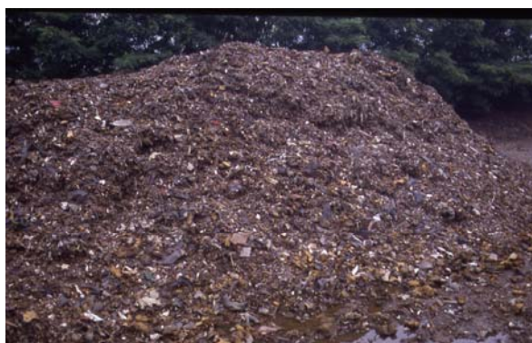
Figura 4.14 Cumulo di fluff (frazione leggera derivante dalla separazione). Figura 4.15. Dilavamento del fluff
