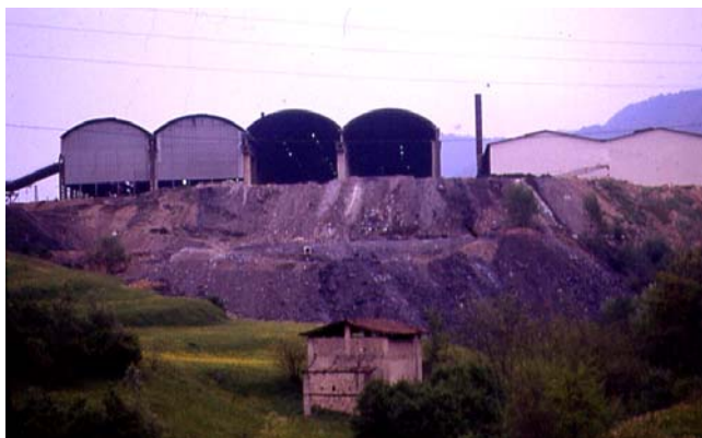
Figura 4.5. Precario accumulo di fumi di forno elettrico. Figura 4.6. Significativo stoccaggio temporaneo di fumi
