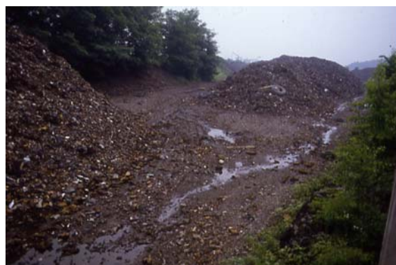
Figura 4.14 Cumulo di fluff (frazione leggera derivante dalla separazione). Figura 4.15. Dilavamento del fluff
