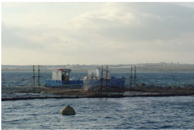
Fig. 26: alimentazione in flusso d'acqua da natante
