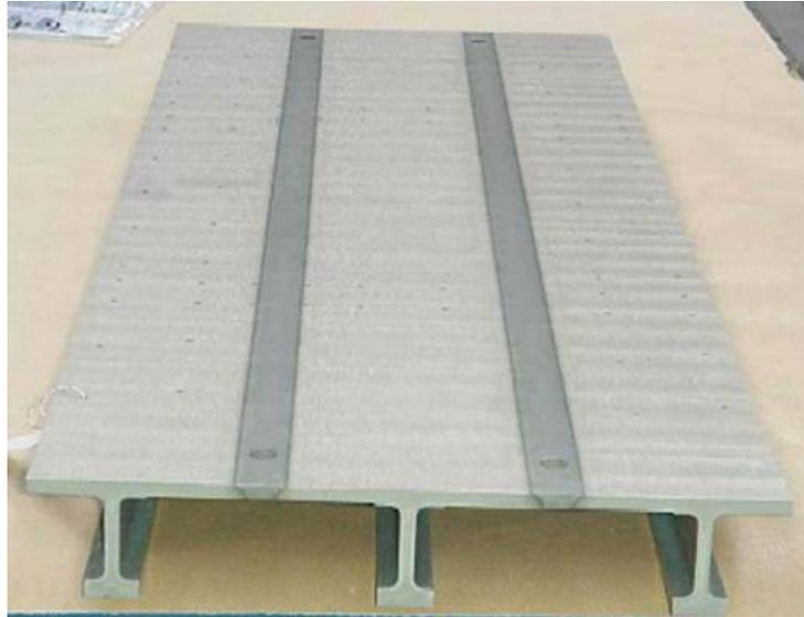
Figura 23 Applicazione della saldatura Friction Stir Welding ad un particolare di Airbus
