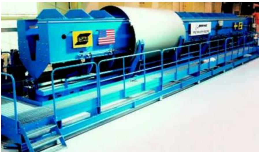
Figura 24 Impianto per il Friction Stir Welding
