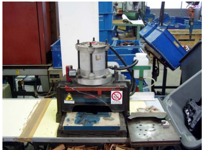
Foto 19 – pressa pneumatica per assemblaggio
