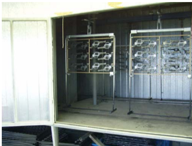
Foto 17 – forno per essiccamento pezzi
