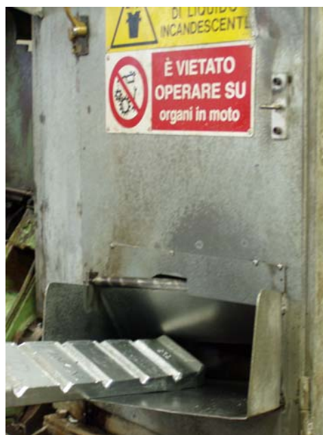
Foto 4 – inserimento zama in pressofusore
