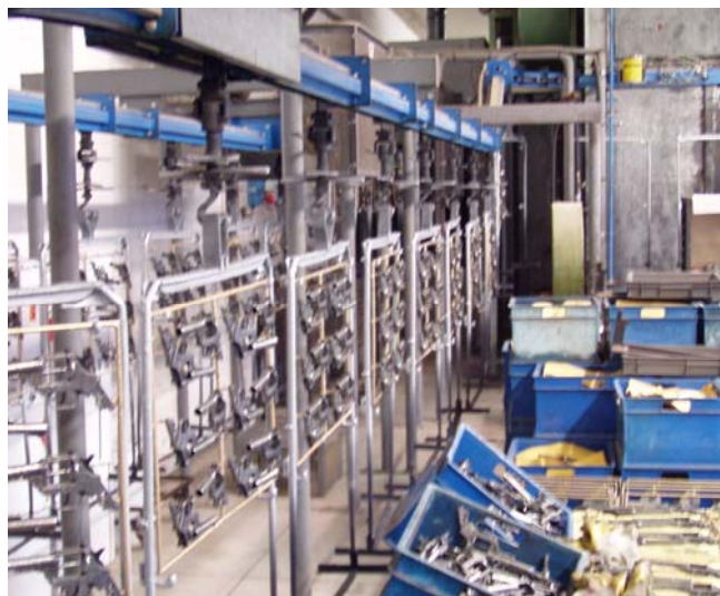
Foto 16 – nastro trasportatore reparto verniciatura
