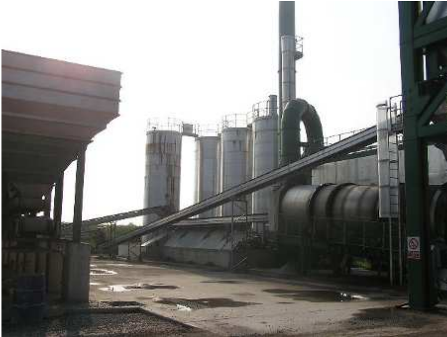
Figura 2-8 – Impianto di pretrattamento (essiccatore).
