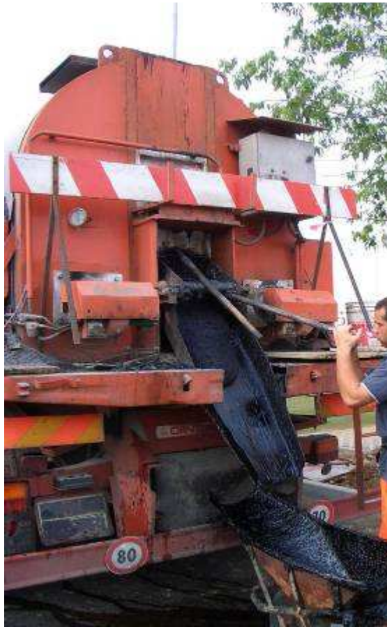
Figura 4-3 – Prelevamento di asfalto colato da “bonza”.
