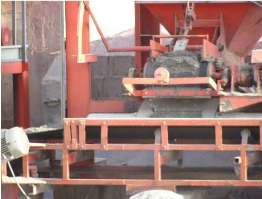
Figura 2-6 – Tramogge di predosatura ponderale: particolare.
