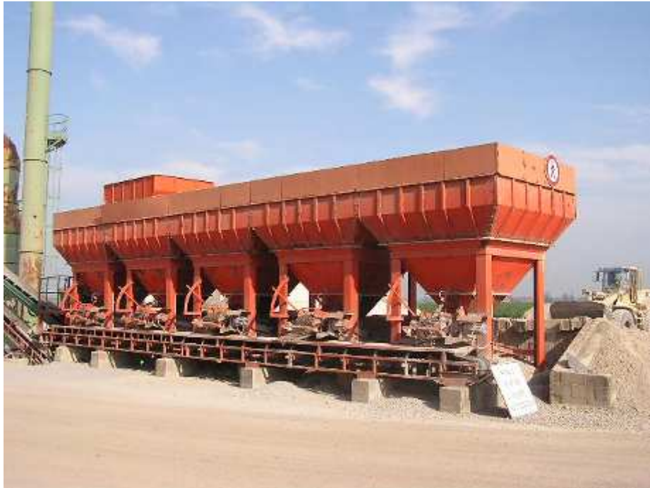
Figura 2-5 – Tramogge di predosatura ponderale.
