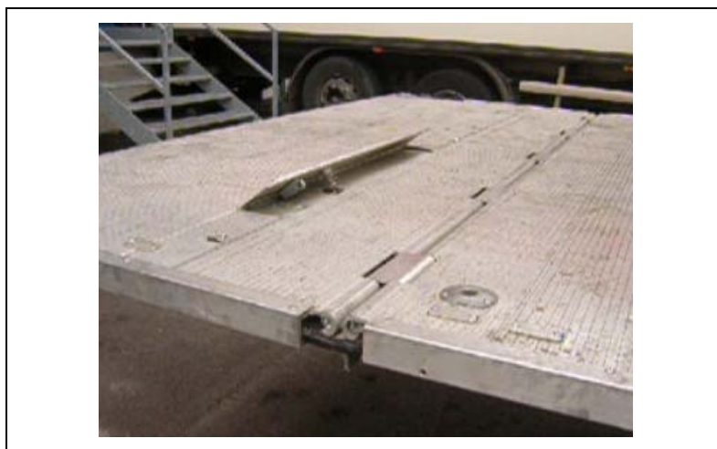
particolare di sponda caricatrice retrattile aperta con roll on in posizione
