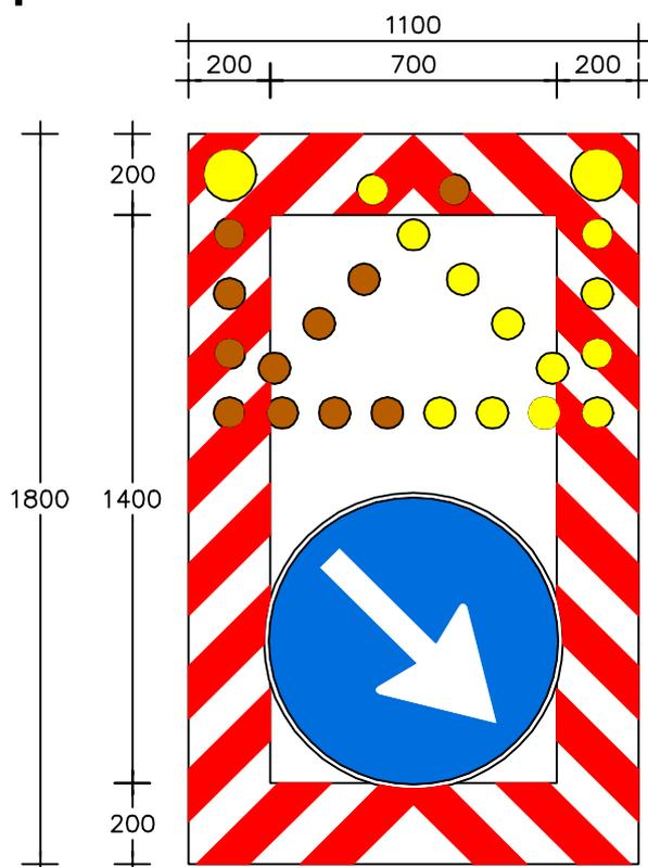
**SEGNALE MOBILE DI PROTEZIONE PER CHIUSURA CORSIA DI SORPASSO (FIG. 401 - ART. 39 COD. D. STRADA)**
