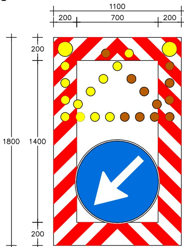
**SEGNALE MOBILE DI PROTEZIONE PER CHIUSURA CORSIA DI MARCIA (fig. 401 - ART. 39 Cod. della Strada)**
