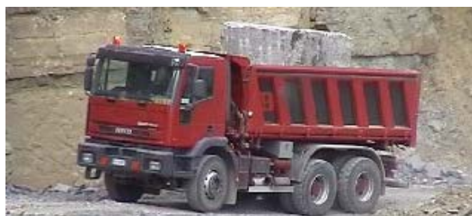
Fig. 07 L'allontanamento del blocco di pietra serena mediante autocarro
