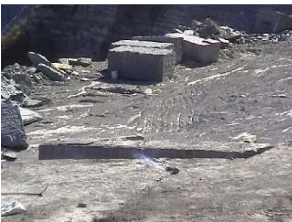
Fig. 86 Taglio con miccia detonante con innesco a miccia a lenta combustione acceso
