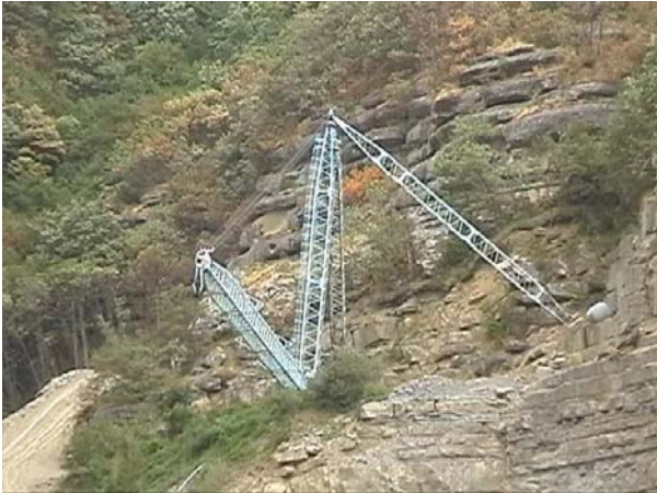
Fig. 94 e 95 apparecchio di sollevamento tipo Derrick installato alla sommità della cava
