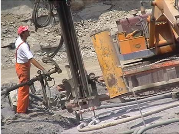
Fig. 70 Tagliablocchi installato sul braccio di un escavatore cingolato, conduttore apparecchiatura
