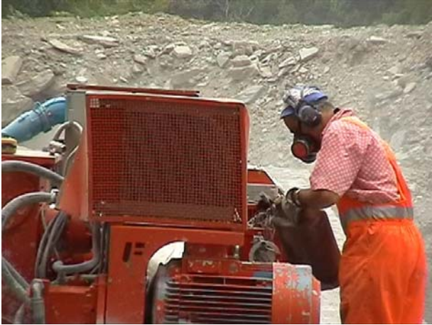
Fig. 80 Rifornimento con olio lubrificante biodegradabile, della sega meccanica a catena con denti diamantati
