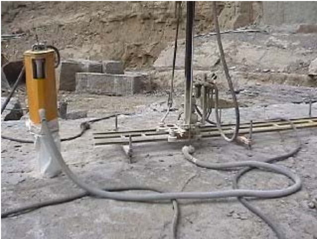
Fig. 85 Tagliablocchi, con sistema di aspirazione delle polveri
