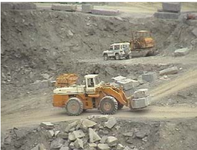
Fig. 97 Caricamento e trasporto dei blocchi con pala meccanica gommata dotata di forche
