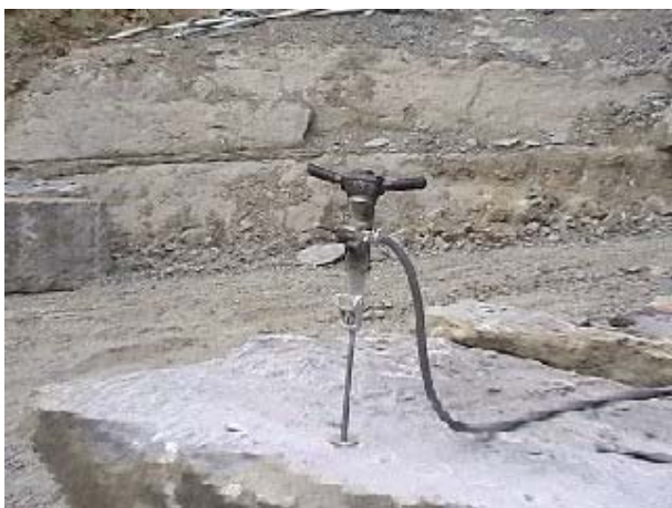
Fig. 24 Martello pneumatico con cappuccio copriforo
