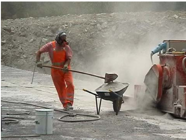
Fig. 79 Sega meccanica a catena con denti diamantati, allontanamento manuale delle polveri di segagione
