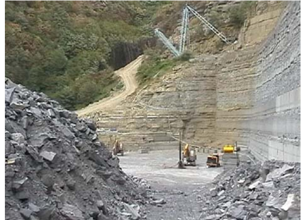
Fig. 94 e 95 apparecchio di sollevamento tipo Derrick installato alla sommità della cava
