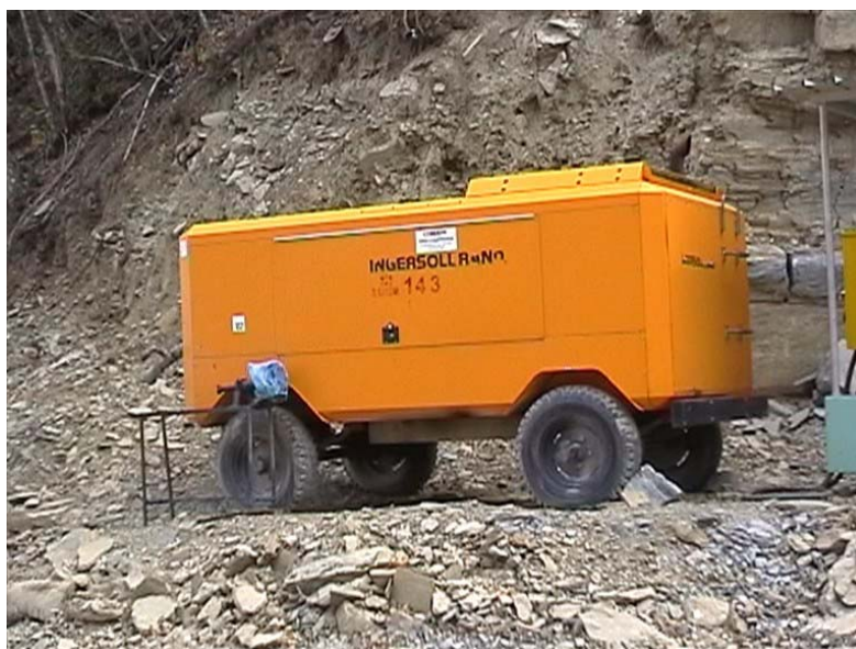
Fig. 66 Motocompressore silenziato per la produzione di aria compressa
