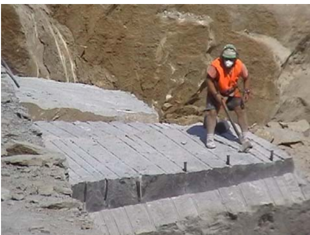
Fig. 88 Attestatura di un blocco con punciotti e mazza e distacco del materiale da scartare
