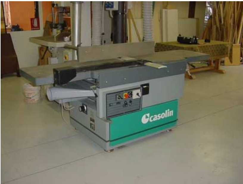
Foto n. 7 - pialla a filo e spessore marcata CE: il sistema di protezione dei coltelli della pialla a filo richiede un'attenta lettura del manuale d'istruzioni per l'uso, in quanto esistono modalità operative diverse in base alle dimensioni del pezzo da lavorare.
