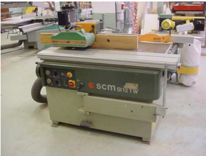
Foto n. 5 - combinata con Toupie dotata di avanzamento automatico e sega circolare dotata di cuffia di protezione.
