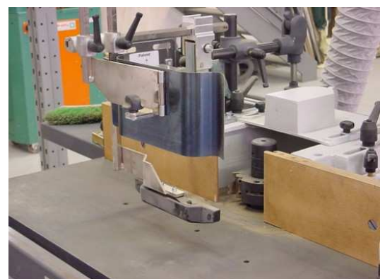
Foto n. 6 - particolare delle protezioni della fresatrice "toupie":
