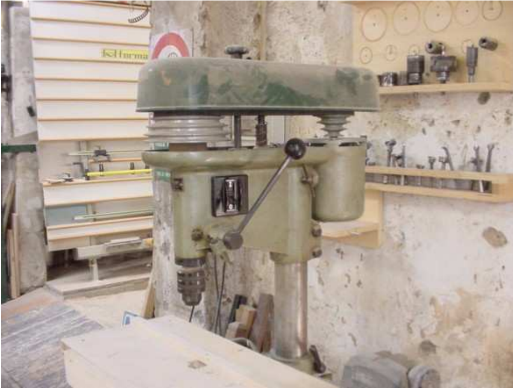
Foto n. 9 - trapano a colonna "datato" sprovvisto di protezioni.
