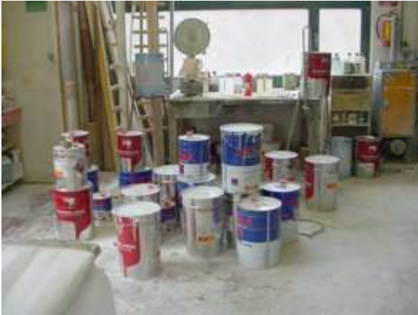
Foto n. 19 - ambiente di lavoro inquinato da polvere prodotta dalle operazioni di carteggiatura e da vapori di solventi. I contenitori di vernici e solventi non sigillati sono accatastati nella zona dove si opera la carteggiatura in quantità eccessiva rispetto alla quantità giornalmente necessarie alle lavorazioni, inoltre è evidente la mancanza di un apposito luogo di stoccaggio dei solventi e delle vernici.
