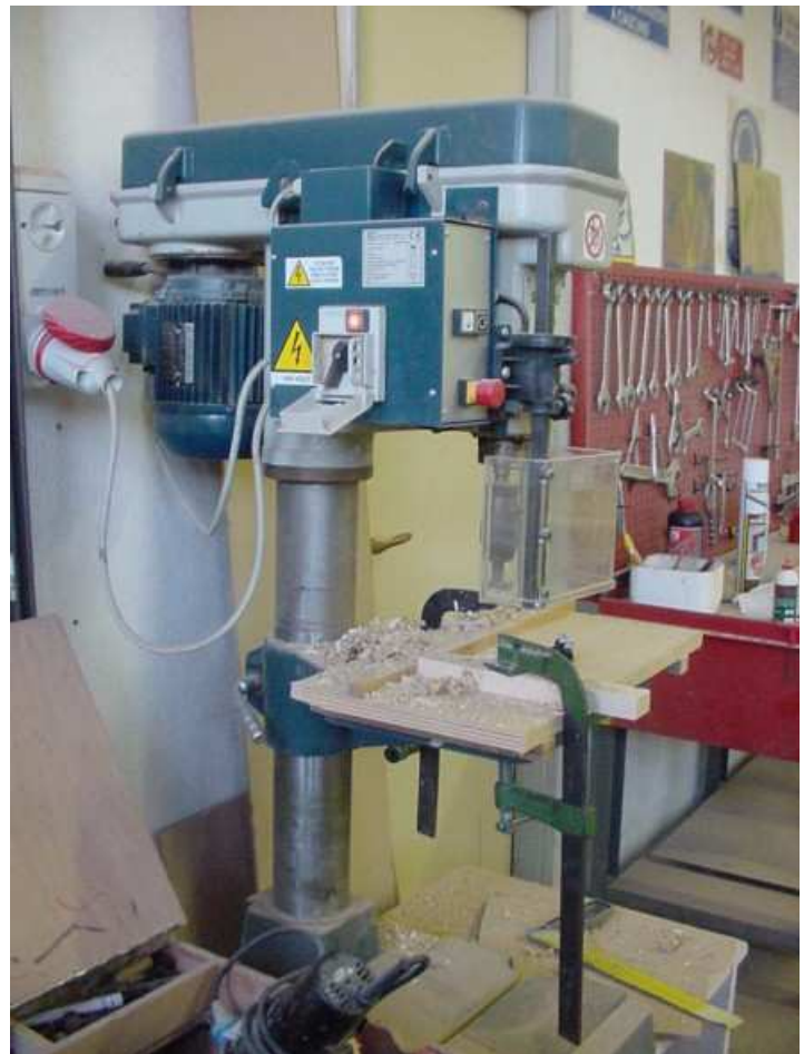
Foto n. 10 - trapano marcato CE dotato delle più recenti protezioni tra cui schermo (paraschegge e contro il contatto con l'utensile) e microinterruttore di sicurezza.
