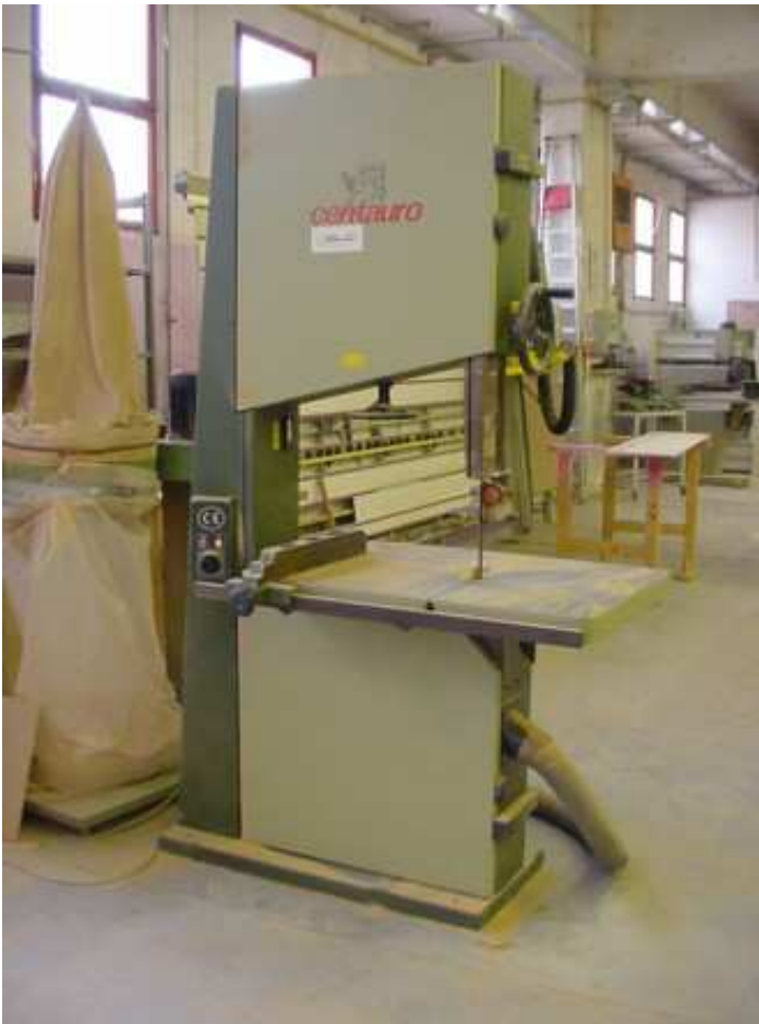
Foto n. 4 - sega a nastro con marcatura CE: la protezione della lama è regolabile tramite volantino.
