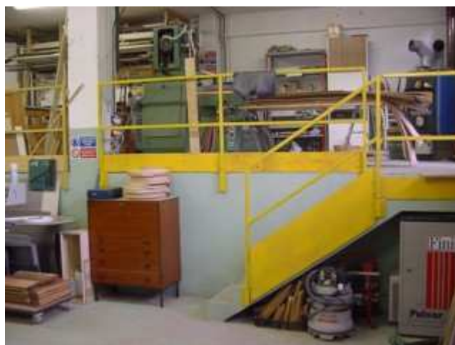
Foto n. 18: Ambiente di lavoro sopraelevato dotato di parapetti regolari. Sono stati inoltre verniciati di giallo per essere più evidenti.
