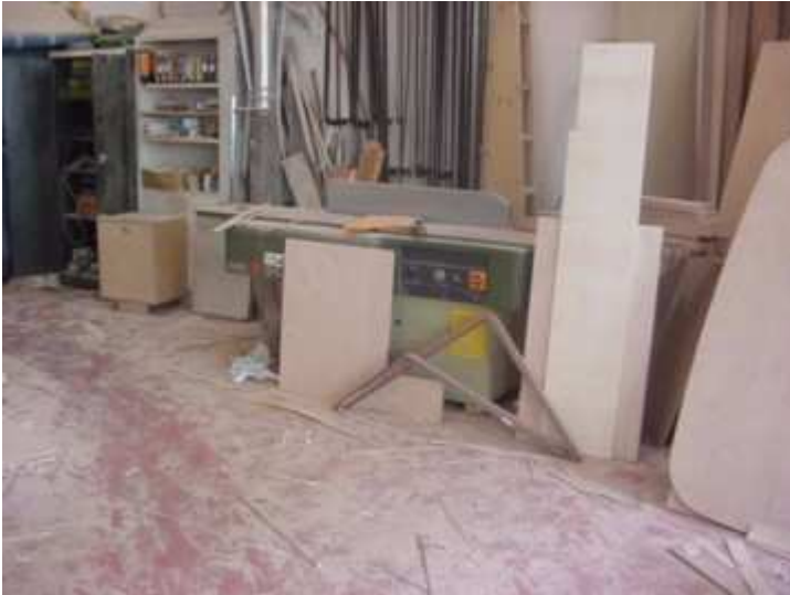
Foto n. 22 - ambiente di lavoro con evidente presenza di polvere, trucioli e pezzi di legno. L'ordine e la pulizia non sono organizzati sistematicamente.
