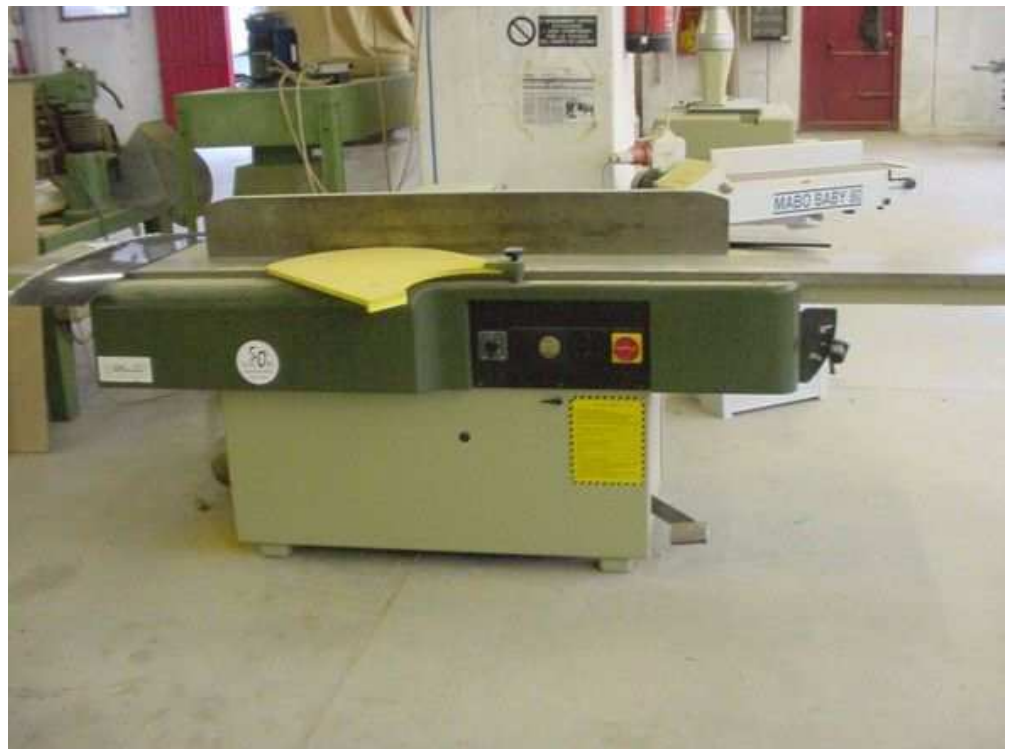
Foto n. 8 - pialla a filo dotata di protezione "classica" dei coltelli
