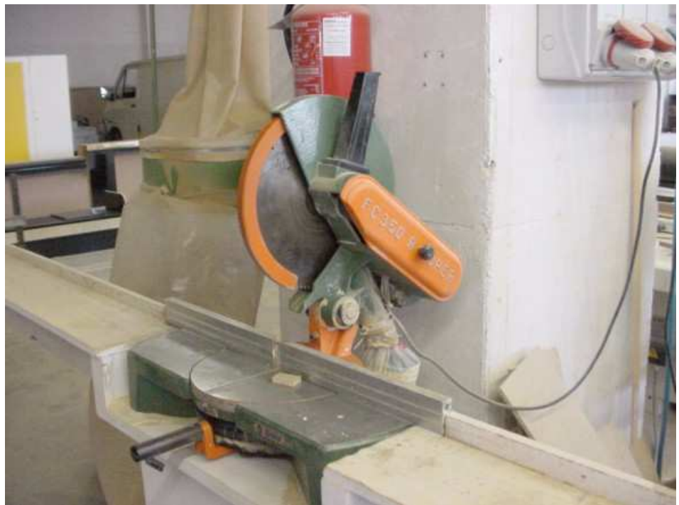
Foto n. 12 - trancatrice a disco di non recente produzione provvista di protezione della lama e raccordo "posticcio" al collettore di aspirazione dei trucioli.
