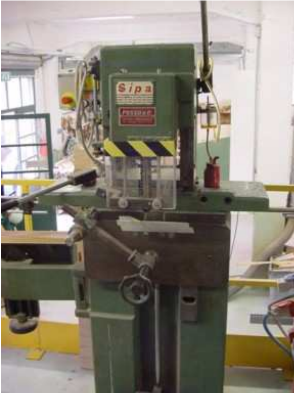
Foto n. 13 - Cavatrice a catena non recente provvista di carter di protezione della catena.
