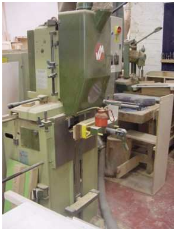
Foto n. 14 -cavatrice a catena CE. La catena è completamente segregata dal carter di protezione, il carter è dotato di oblò per la visione del pezzo in lavorazione.
