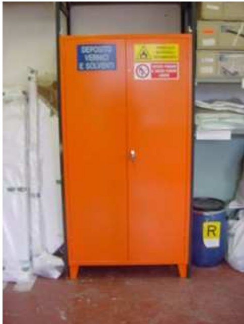
Foto n. 20 - ambiente di lavoro pulito e razionalmente organizzato in cui i solventi e le vernici vengono conservati sigillati entro apposito armadio metallico. I solventi esausti sono stoccati prima dello smaltimento in apposito bidone di colore blu.
