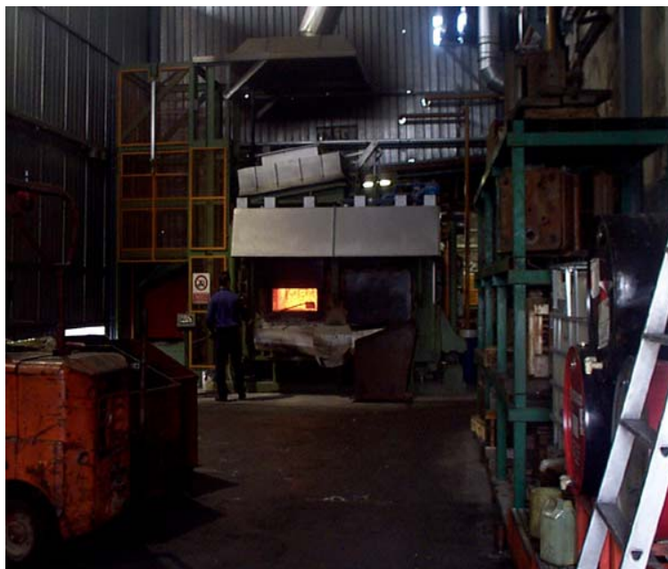
Foto 4 Fusione in forno a torre con caricamento automatizzato.
