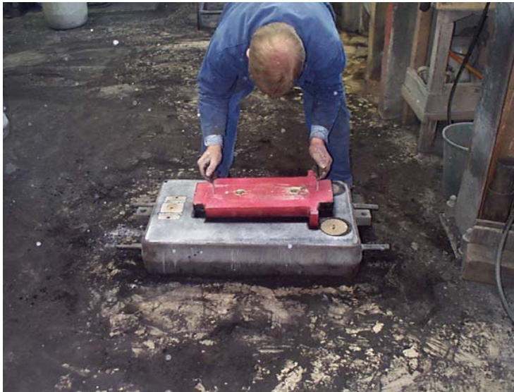
Foto 2 Formatura manuale, inserimento del modello.
