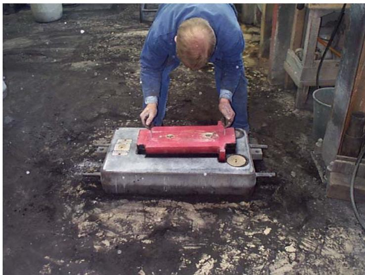
Foto 2 Formatura manuale, inserimento del modello.
