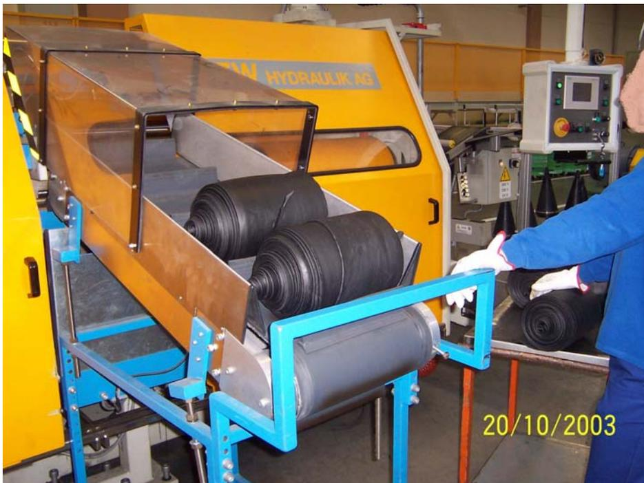
Figura 13 - Operazione di carico della trafila
