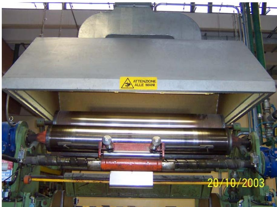
Figura 10 - Impianto di aspirazione localizzato
