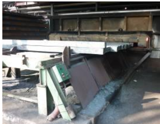
SPINTA BILLETTE NELLA BOCCA DI CARICO DEL FORNO E SLITTA DI CARICO
