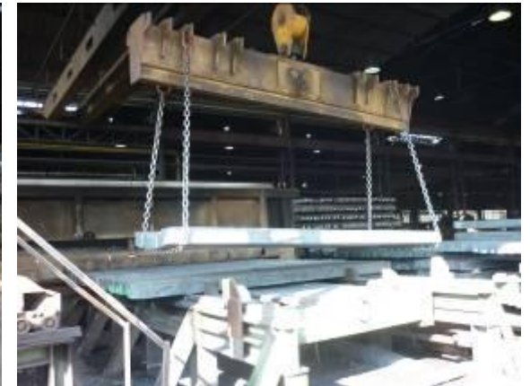
POSIZIONAMENTO BILLETTE SU CARICATORE (2 OPERATORI)
