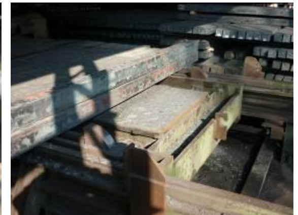
SPINTA BILLETTE NELLA BOCCA DI CARICO DEL FORNO E SLITTA DI CARICO
