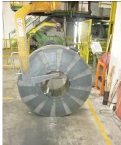
MOVIMENTAZIONE MEDIANTE CARROPONTE
