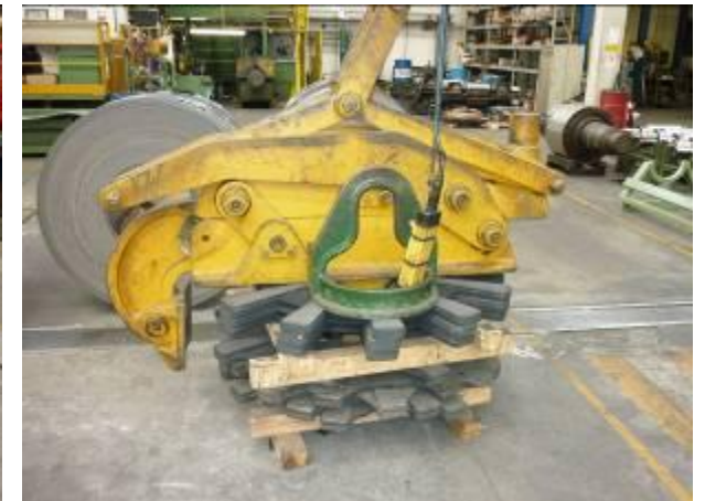
SISTEMA DI IMBRACATURA CHE CONSENTE IL CARICAMENTO DEL FORNO
