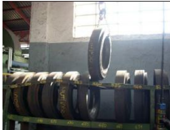
ESEMPIO DI SOLLEVAMENTO E TRASPORTO STAMPO AD ANELLO CON CARROPONTE
