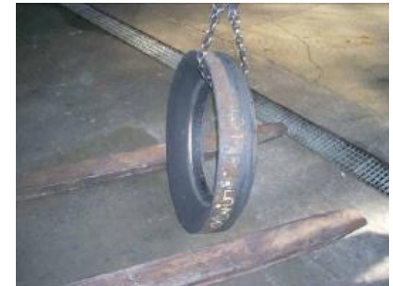
ESEMPIO DI SOLLEVAMENTO E TRASPORTO STAMPO AD ANELLO CON CARROPONTE
