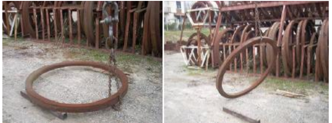
ESEMPIO SOLLEVAMENTO STAMPO CON AUTOGRU DA MAGAZZINO ESTERNO
