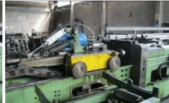
SISTEMA DI TRAFILATURA CON UNICO CARRO DI TIRO
