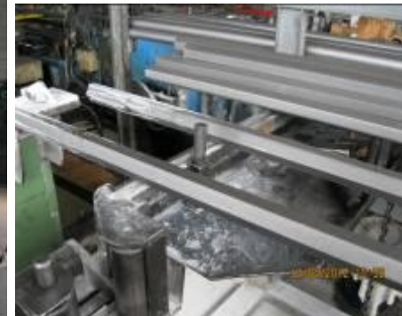
POSIZIONAMENTO BARRE BOCCA FILIERA SISTEMA ANTI-ROTOLOAMENTO
