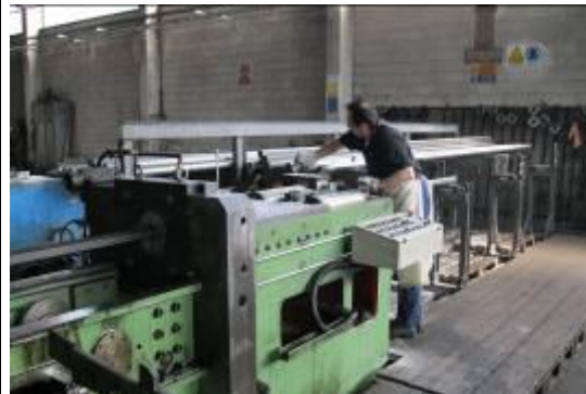
POSIZIONAMENTO BARRE BOCCA FILIERA SISTEMA ANTI-ROTOLOAMENTO
