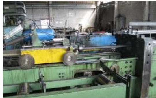
SISTEMA DI TRAFILATURA CON UNICO CARRO DI TIRO
