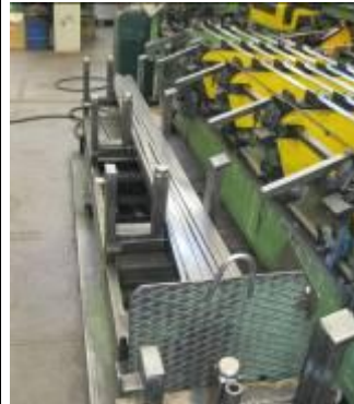
CONTENIMENTO BARRE SPINTA IN FASCIATRICE CON SISTEMA A RULLI
