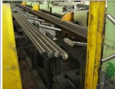
ALIMENTAZIONE AUTOM. RULLATRICE REALIZZAZIONE FASCIO DOPO LA RULLATURA TAGLIO E BISELLATURA
