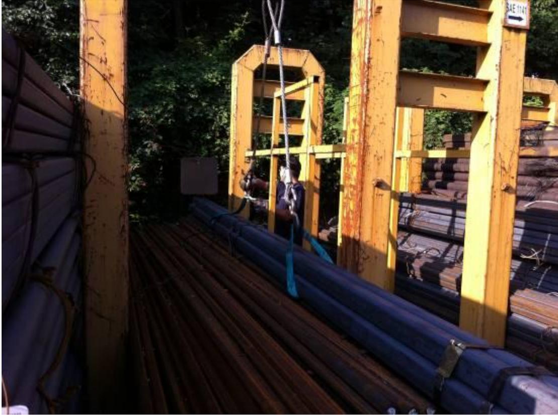
**Ripresa del fascio di billette per il trasferimento dal magazzino ai reparti di produzione**
