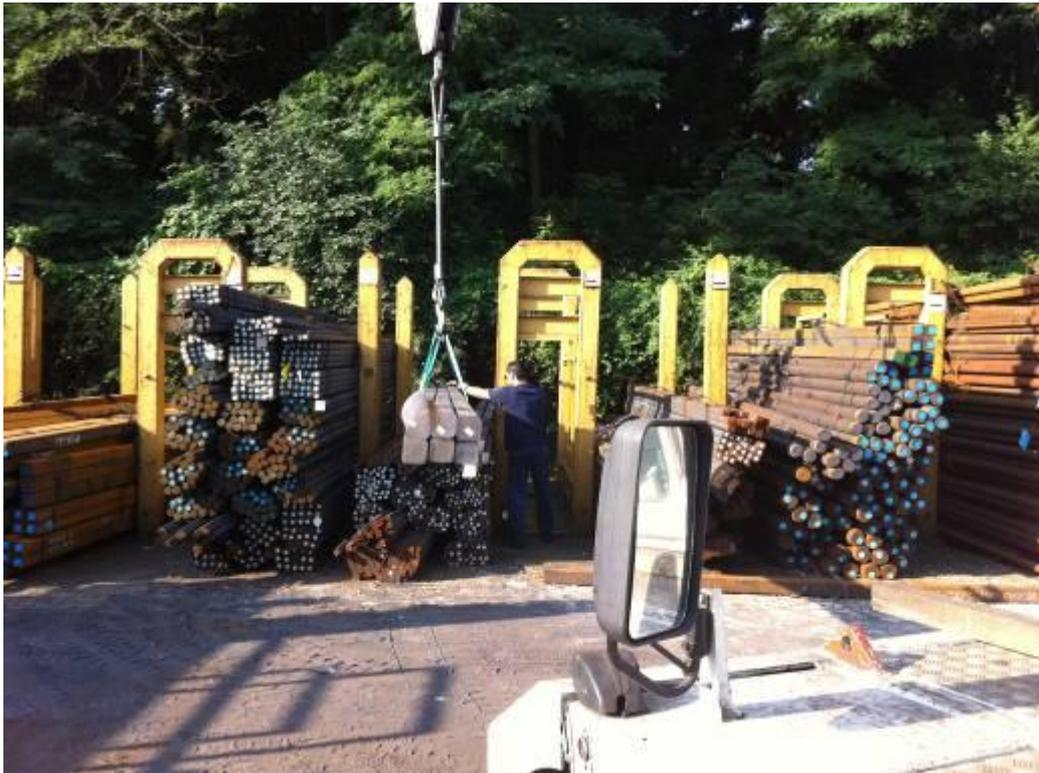
Posizionamento nel modulo stoccaggio e sgancio - uomo nel tunnel (gabbia) di protezione
