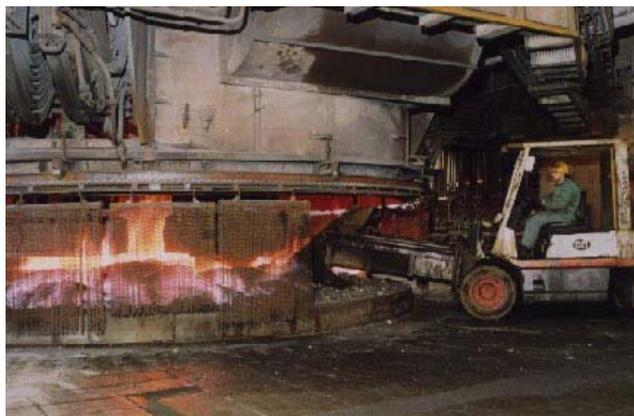
Lo spillaggio della ferrolega fusa avviene periodicamente con cicli di 2 – 4 ore. Durante la colata vengono eseguite le seguenti operazioni.
