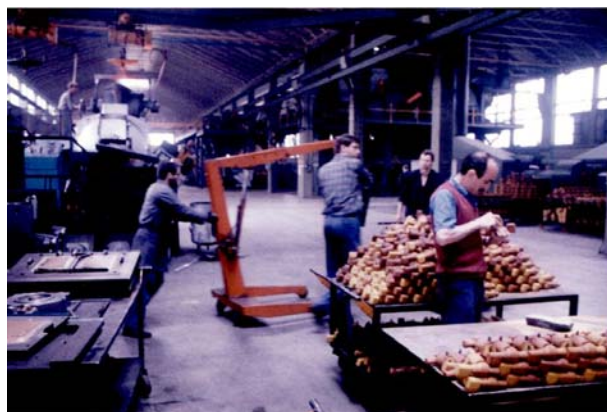
Figura 3.4.2. Rifinitura con raspe manuali di anime preparate con processo a caldo
