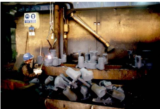
Figura 3.9.3. Figura 3.9.4. Operazioni di criccatura effettuate con cannelo
