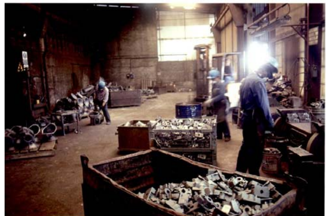
Figura 3.9.2. Impianti di molatura a banco, operazioni di movimentazione manuale dei getti
