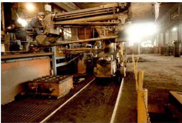
Figura 3.6.3. Formatura manuale a verde: inserimento della terra effettuato tramite macchina a lancio di terra Figura 3.6.4. Forme pronte per la colata
