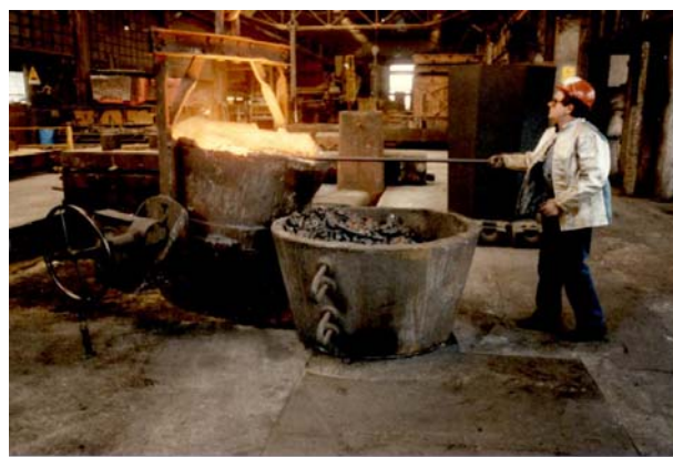
Successiva scorifica condotta con raspa manovrata a mano dalla siviera alla paiola di raccolta
