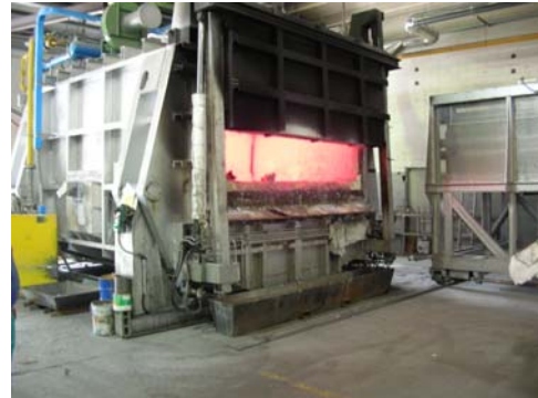
Figura 3.3.15. Forno a riverbero con porta di carico parzialmente aperta. A destra il sistema di caricamento mobile
