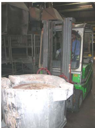
Figura 3.7.7. Trasporto di siviera alla zona di colata con carrello elevatore
