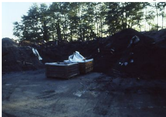
Figura 4.2. Piazzali esterni. Depositi non tutelati rispetto al dilavamento meteorico di terre di fonderie (“depositi temporanei”) e di cassoni con forme in resina non idonee. Figura 4.3. Sottofondi adiacenti a impianti produttivi realizzati con terre di fonderia esauste: conseguente inquinamento delle acque per dilavamento e del suolo
