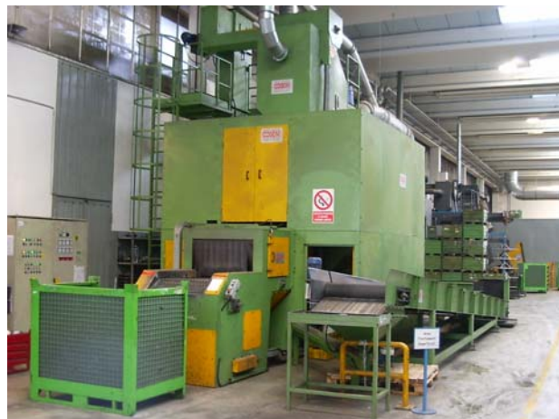
Figura 3.8.12. Isola robotizzata di sterratura, smaterozzatura, sbavatura dotata di nastro trasportatore per alimentare i getti da lavorare. Fotografia scattata durante intervento di manutenzione (segregazione aperta).
