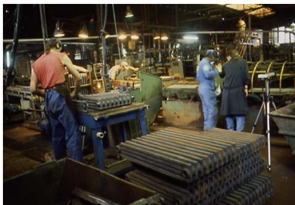
Figura 3.10.2. Figura 3.10.3. Linea di tornitura, montaggio e prova idraulica
