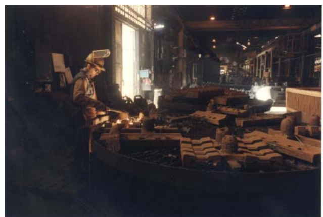
Figura 3.9.3. Figura 3.9.4. Operazioni di criccatura effettuate con cannello
