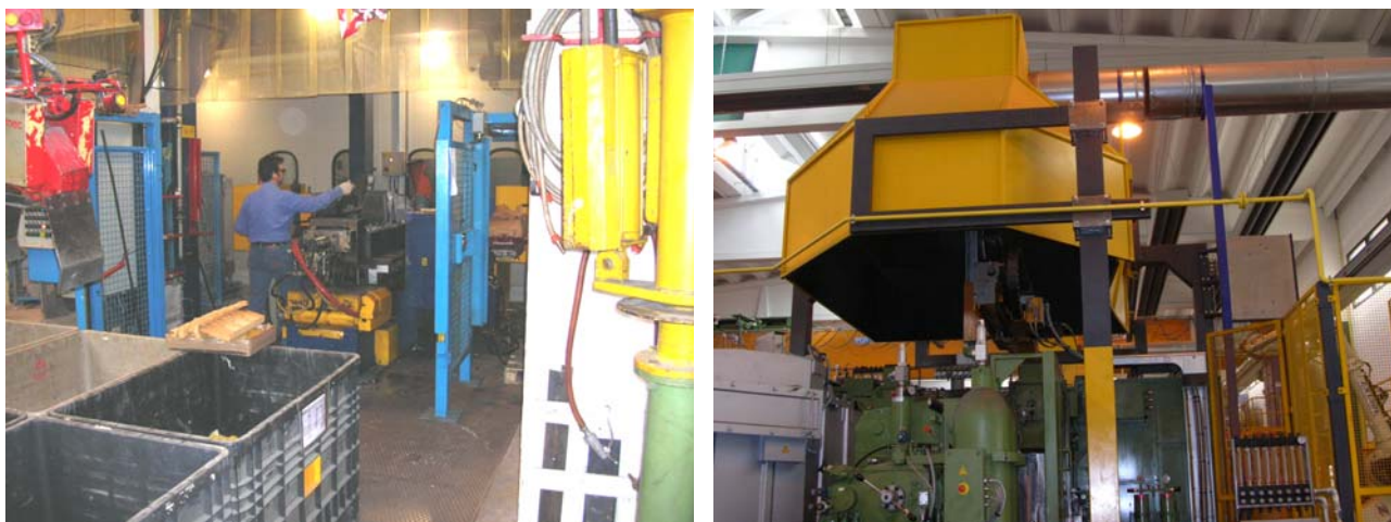
Figura 3.7.11. Isola di stampaggio in conchiglia posta sotto aspirazione, le bandelle in plastica consentono un efficace convogliamento del flusso d'aria. Figura 3.7.12. Cappa di aspirazione a servizio di isola di pressocolata
