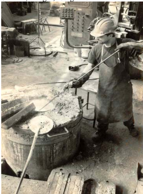
Forno a crogiolo utilizzato come forno di colata per leghe non ferrose con alimentazione tramite tazza del metallo allo stampo
