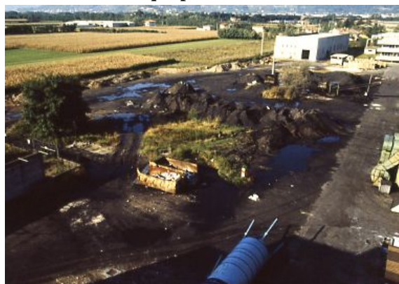
Figura 4.2. Piazzali esterni. Depositi non tutelati rispetto al dilavamento meteorico di terre di fonderie (“depositi temporanei”) e di cassoni con forme in resina non idonee. Figura 4.3. Sottofondi adiacenti a impianti produttivi realizzati con terre di fonderia esauste: conseguente inquinamento delle acque per dilavamento e del suolo
