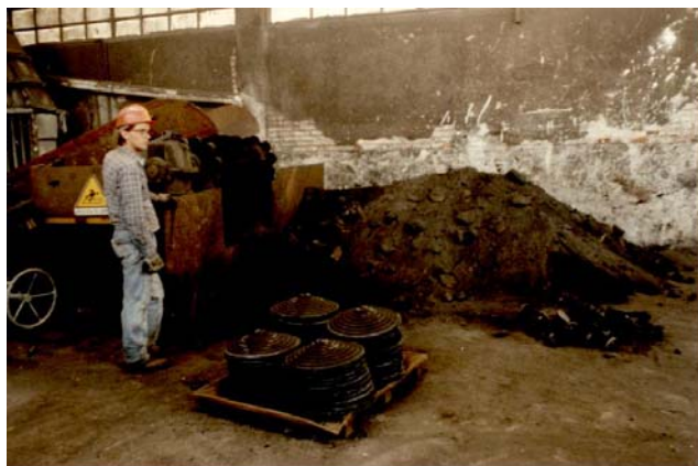
Figura 3.8.2. Raccolta con forca dei getti da distaffatore a griglia vibrante e stoccaggio del getto in carrello e delle materozze in cassone
