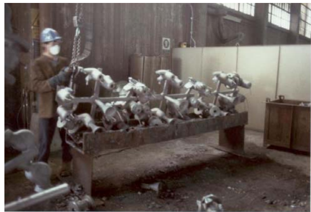
Figura 3.8.5. Smaterozzatura dei getti effettuata con mazza Figura 3.8.6. Posizionamento dei getti su banco per effettuare il taglio materozze
