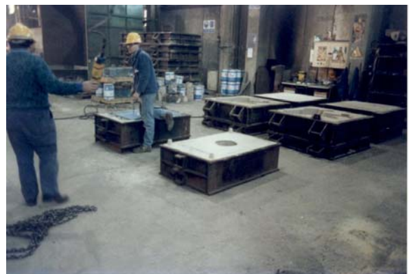
Figura 3.6.3. Formatura manuale a verde: inserimento della terra effettuato tramite macchina a lancio di terra Figura 3.6.4. Forme pronte per la colata
