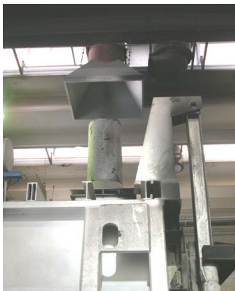
Figura 3.3.10. Forno fusorio a tino per leghe di alluminio con condotto espulsione fumi aspirati
