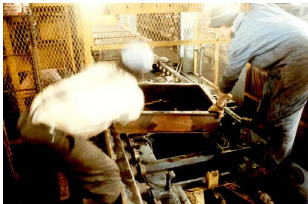
Figura 3.11.2. Ripristino rivestimento refrattario di usura di un canale di colata di forno a crogiolo
