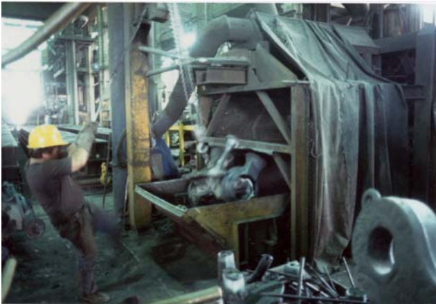
Figura 3.8.3. Estrazione del getto dal distaffatore tramite paranco (e forza muscolare) Figura 3.8.4. Raccolta del getto da distaffatore a griglia vibrante con pala gommata
