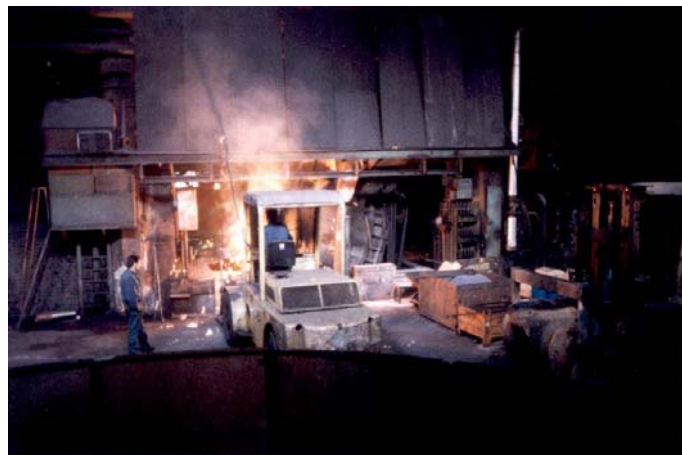
Spillaggio di ghisa da forno a cubilotto con siviera sostenuta da carrello
