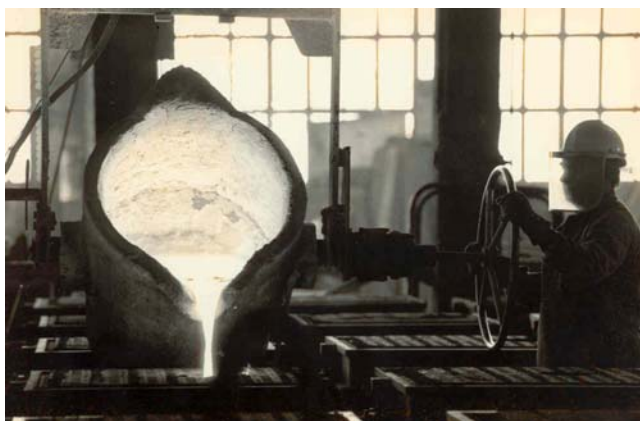
Figura 3.7.4. Colata in forme refrattarie tramite rotazione manuale della siviera con volante e riduttore
