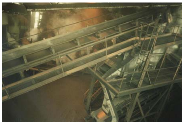
Figura3.5.3 . Figura 3.5.4. Impianto preparazione terre a verde. Dispersione di polvere e vapori dai nastri
