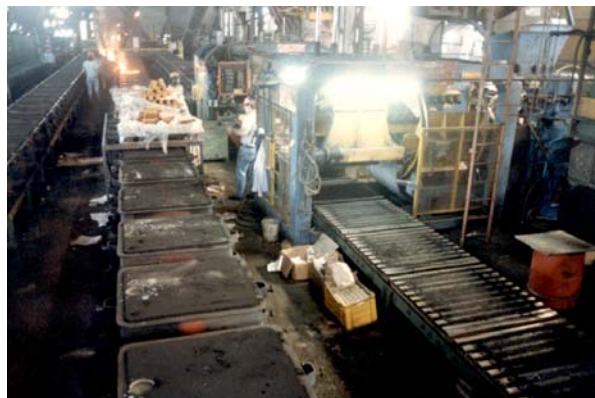
Figura 3.6.9. Figura 3.6.10. Formatura in linea automatizzata. Postazioni di ramolaggio effettuato dagli operatori con presidio di aspirazione (anime hot-box) e senza aspirazione
