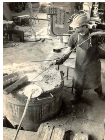
Figura 3.7.5. Colata con tazza in macchina conchigliatrice Figura 3.7.6. Prelievo manuale con tazza del metallo da crogiolo
