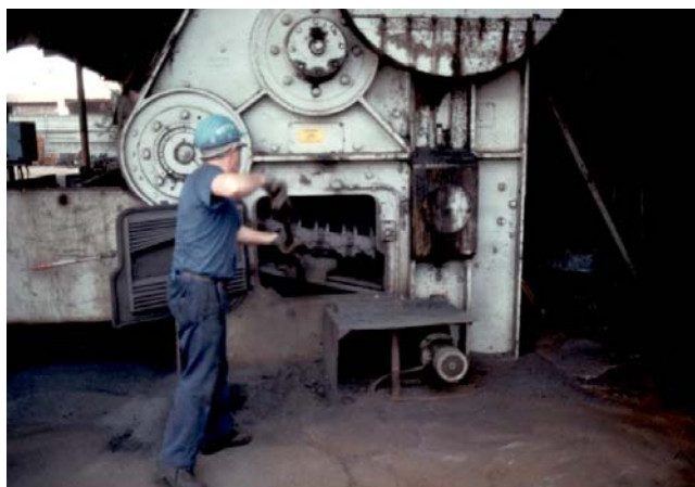
Figura 3.8.13. Macchina sterratrice per getti in ghisa. Intervento di disincaglio della colcea
