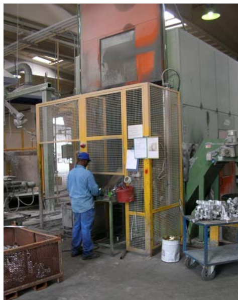
Figura 3.8.14. Griglia vibrante di distaffatore presidiata da aspirazione Figura 3.8.15. Macchina sterratrice robotizzata posta in cabina insonorizzata
