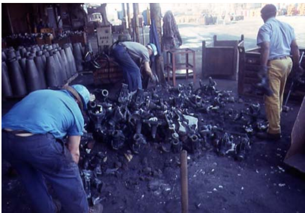
Figura 3.8.5. Smaterozzatura dei getti effettuata con mazza Figura 3.8.6. Posizionamento dei getti su banco per effettuare il taglio materozze
