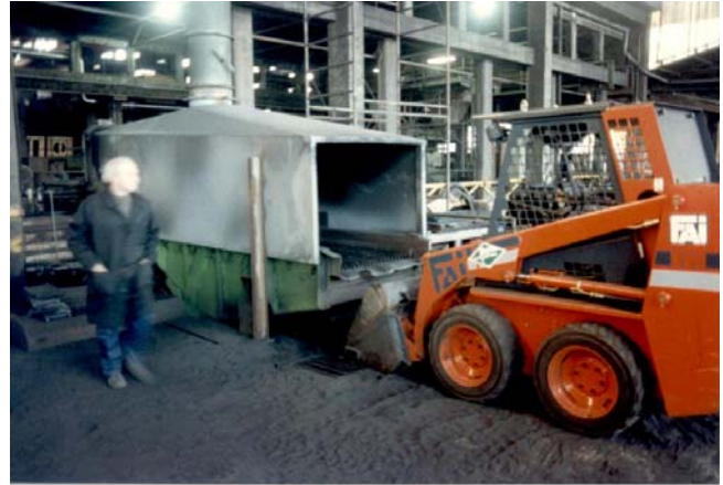
Figura 3.8.3. Estrazione del getto dal distaffatore tramite paranco (e forza muscolare) Figura 3.8.4. Raccolta del getto da distaffatore a griglia vibrante con pala gommata
