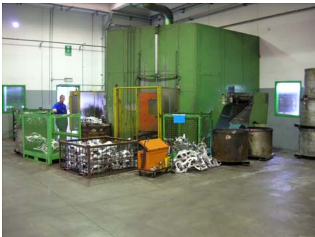
Figura 3.8.12. Isola robotizzata di sterratura, smaterozzatura, sbavatura dotata di nastro trasportatore per alimentare i getti da lavorare. Fotografia scattata durante intervento di manutenzione (segregazione aperta).
