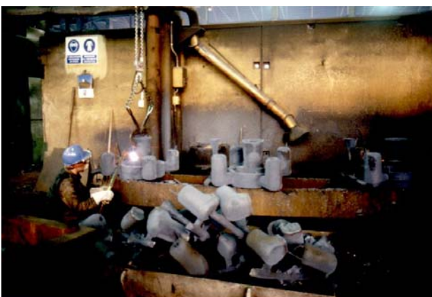
Figura 3.9.3. Figura 3.9.4. Operazioni di criccatura effettuate con cannello
