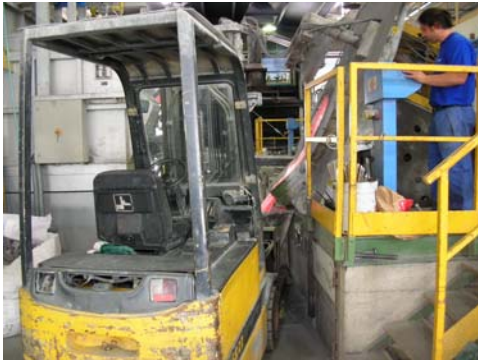
Figura 3.3.15. Forno a riverbero con porta di carico parzialmente aperta. A destra il sistema di caricamento mobile
