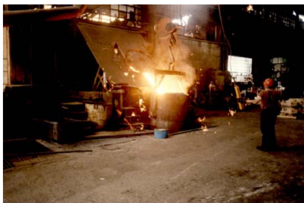
Spillaggio di ghisa in siviera tramite ribaltamento di un forno elettrico a crogiolo
