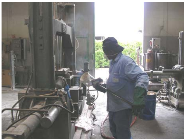
Figura 3.7.5. Colata con tazza in macchina conchigliatrice Figura 3.7.6. Prelievo manuale con tazza del metallo da crogiolo
