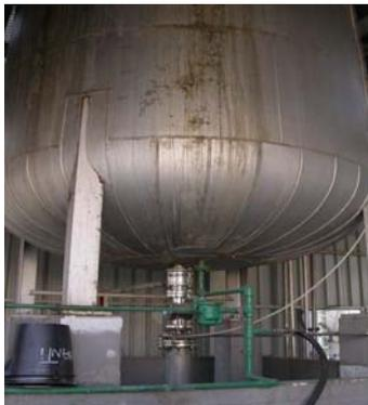
I miscelatori possono essere collocati in una zona dello stabilimento dedicata alla "miscelazione" o in reparti dedicati per tipo di produzione. Sono montati su una struttura metallica fissa che mantiene il miscelatore in posizione sopraelevata in modo da agevolare le operazioni di scarico del prodotto.
