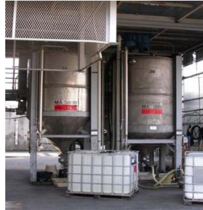
Successivamente il prodotto viene raccolto in un altro miscelatore dove, a seguito di aggiunta di una sostanza addensante, acquisisce le caratteristiche di viscosità necessarie per mantenere nel tempo il comportamento desiderato.
