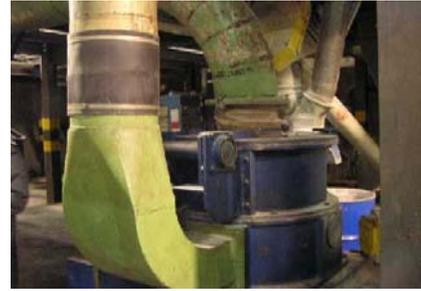
**Mulini ad aria compressa o Micronizzatori:** si raggiungono granulometrie di 5-10  $\mu\text{m}$ ; richiedono aria compressa a 7
