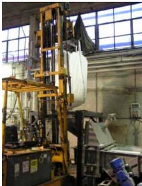
Il carico delle polveri inoltre può avvenire manualmente da sacchi da 25 Kg, fusti da 25 a 150 Kg e big-bags fino a 1000 Kg; in taluni casi con l’ausilio di tagliasacchi e sistemi meccanici di svuotamento. Effettuato il caricamento della tramoggia il materiale viene trasferito, mediante elevatori a tazze o trasportatori a coclea, in serbatoio di stoccaggio o direttamente al miscelatore.
