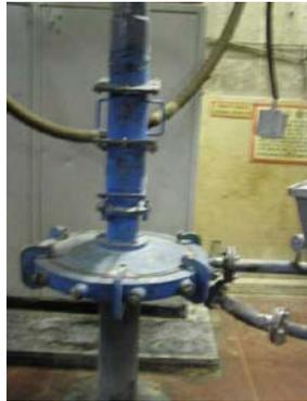
atm per la macinazione e 4/5 atm per l'alimentazione del prodotto dal miscelatore. Il processo di macinazione avviene mediante urto tra le particelle del prodotto. Sono impianti composti da un polmone di carico, da mescolatori sovrapposti e piatti di micronizzazione. Spesso gli impianti sono dotati di un mescolatore polmone e di setacci per effettuare una separazione in base alle granulometrie desiderate.
