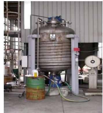
sacchi direttamente nel miscelatore. I tensioattivi generalmente contenuti in fusti, sono resi fluidi mediante riscaldamento a bagnomaria (50 °-80°C) per consentire il trasferimento tramite pescante e pompa.
