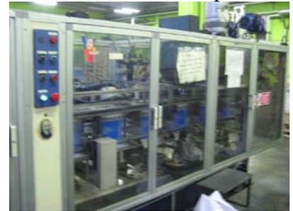
Molto spesso le linee sono dotate di selettori a chiave per il funzionamento in automatico e in manuale. Questi selettori a chiave di norma sono in dotazione esclusivamente al capo reparto e ai meccanici. Qualora le operazioni di regolazione o pulizia dovessero richiedere l'avvio della macchina con i ripari rimossi è necessario utilizzare una pulsantiera con avviamento ad impulsi a uomo presente.
