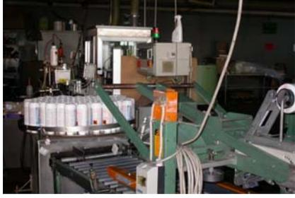
etichettatrici, le confezionatrici, ecc, sono attrezzature e macchine poste in linea con funzionamento semiautomatico o automatico in cui l'intervento dell'operatore è limitato ad alcune operazioni differenti da linea a linea. Anche per le linee di confezionamento, spesso si tratta di prototipi o di componenti o macchine assemblate per le produzioni a cui sono dedicate; l'anzianità di queste macchine corrisponde all'epoca di autorizzazione del formulato o dei formulati a cui sono dedicate.
