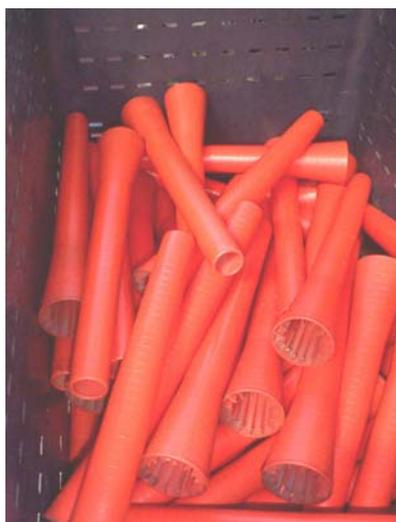
Descrizione: Nelle aziende la movimentazione manuale riguarda lo spostamento di fusi e rocche destinate alla lavorazione e dei loro tubetti di supporto vuoti. Si utilizzano ceste di plastica posizionate tramite carrelli elevatori, da cui gli operatori prelevano i pezzi.
