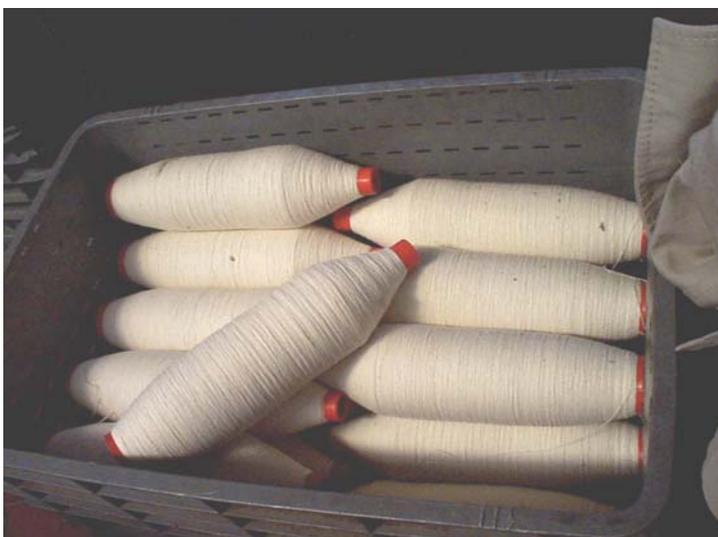
Descrizione: Nelle aziende la movimentazione manuale riguarda lo spostamento di fusi e rocche destinate alla lavorazione e dei loro tubetti di supporto vuoti. Si utilizzano ceste di plastica, posizionate tramite carrelli elevatori, da cui gli operatori prelevano i pezzi.
