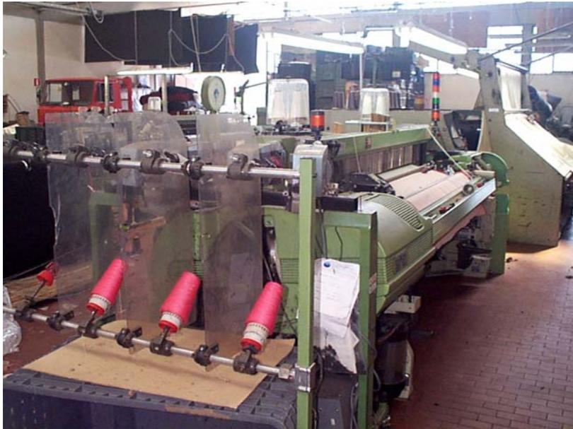
10 Foto 11 Un moderno telaio a controllo elettronico.
