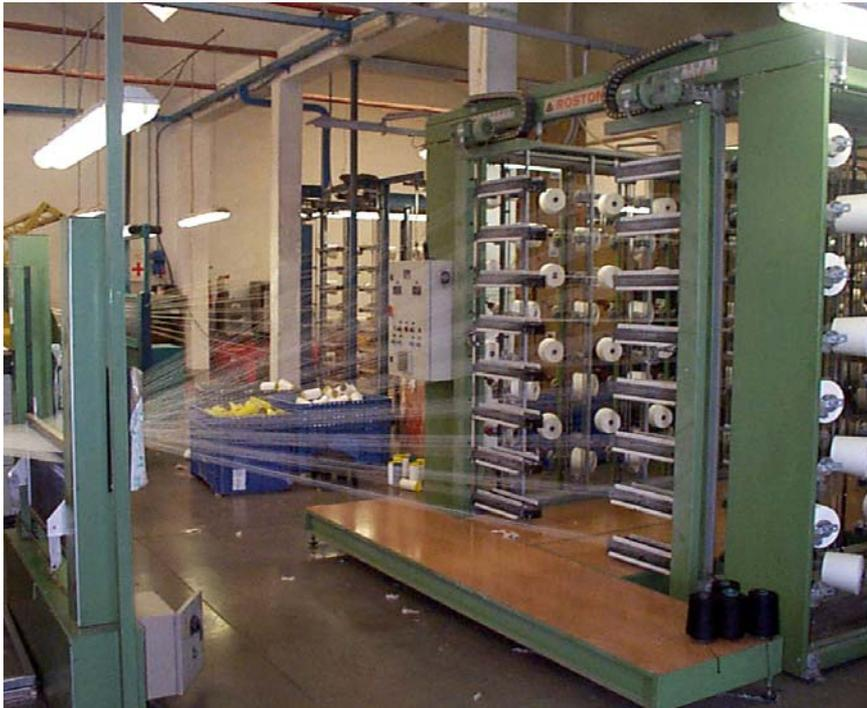
L'orditura viene eseguita su macchine a controllo numerico, dette orditoi, a sempre maggiore contenuto tecnologico, rispetto a quelli a funzionamento meccanico, che vengono trasferiti in aree produttive in via di espansione, quali i paesi dell'est.
