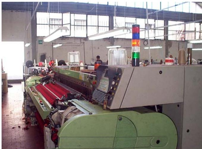
8 *Foto 5 Telaio, in evidenza il pannello di controllo ed i segnali luminosi.*
