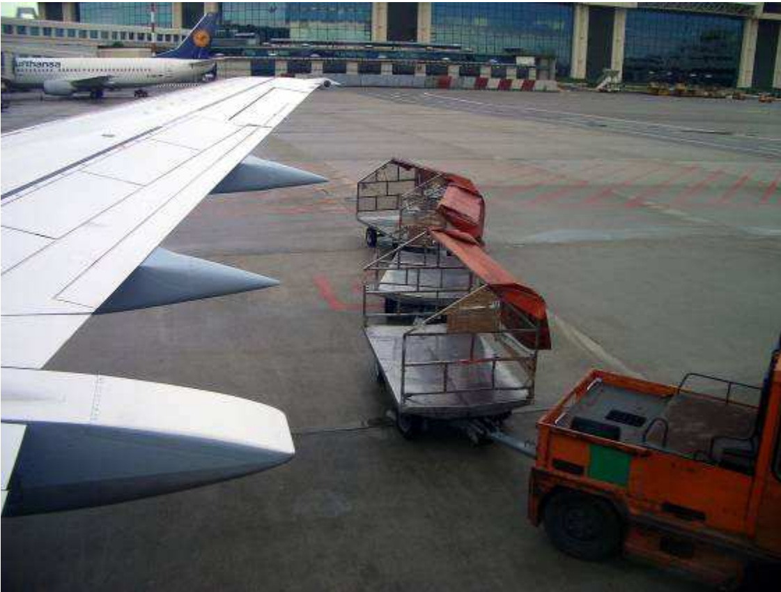
Figura 4-7 – Arrivo attrezzatura per scarico: dolly.
