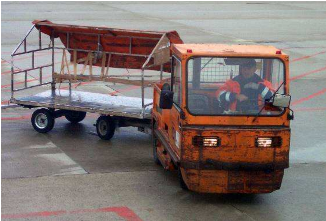
Figura 3-4 – Esempio di carrello “dolly” trainato da trattorino.
