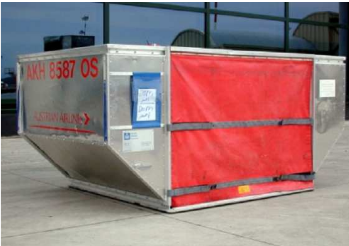
Figura 3-6 – Esempio di ULD (Unit Load Device): igloo.
