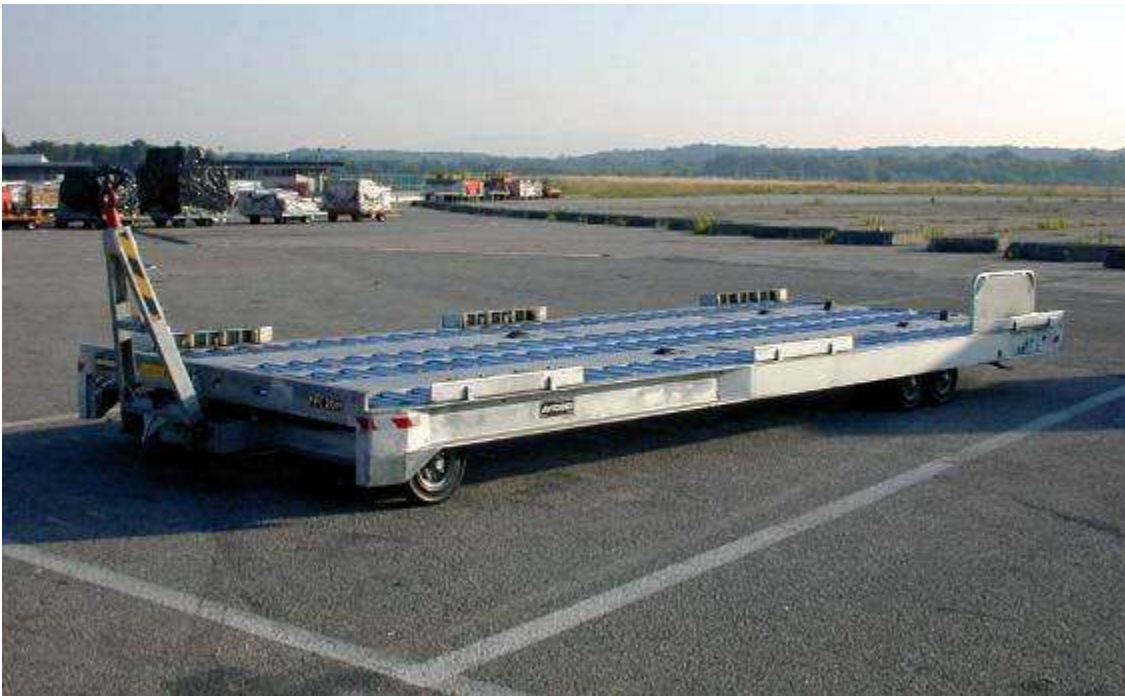
Figura 3-8 – Esempio di "cargo dolly".
